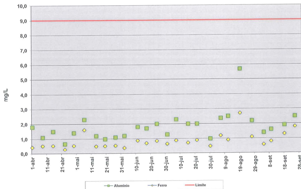
Figura 26. Alumínio e ferro no efluente líquido lançado no período avaliado.
