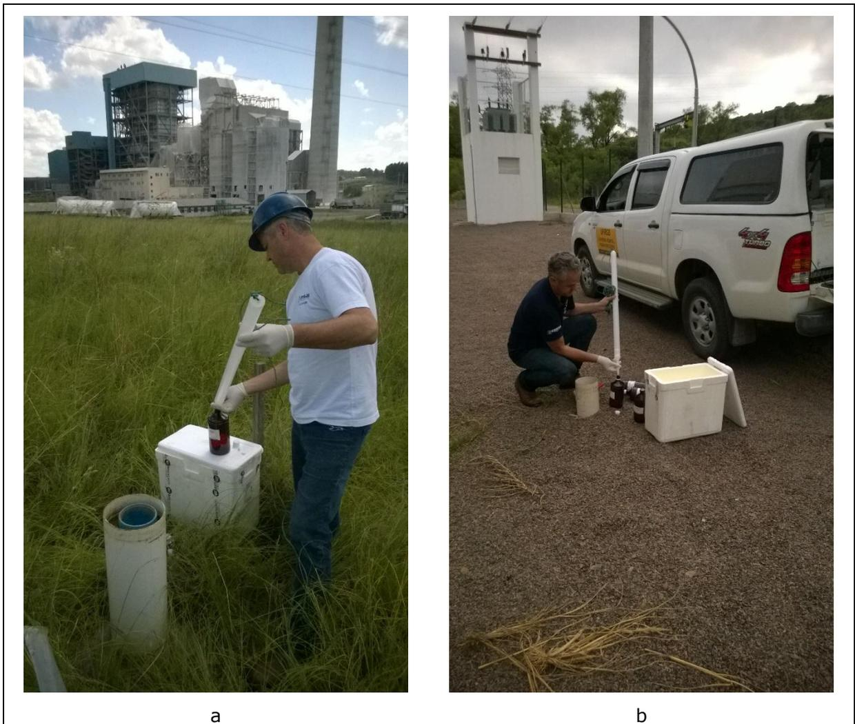
Figura 6. Coletas de amostra no poço PM-7 (a) e PM-15 (b), realizadas nos dias 02 e 03 de fevereiro de 2015 com amostrador descartável tipo *beiler*.
