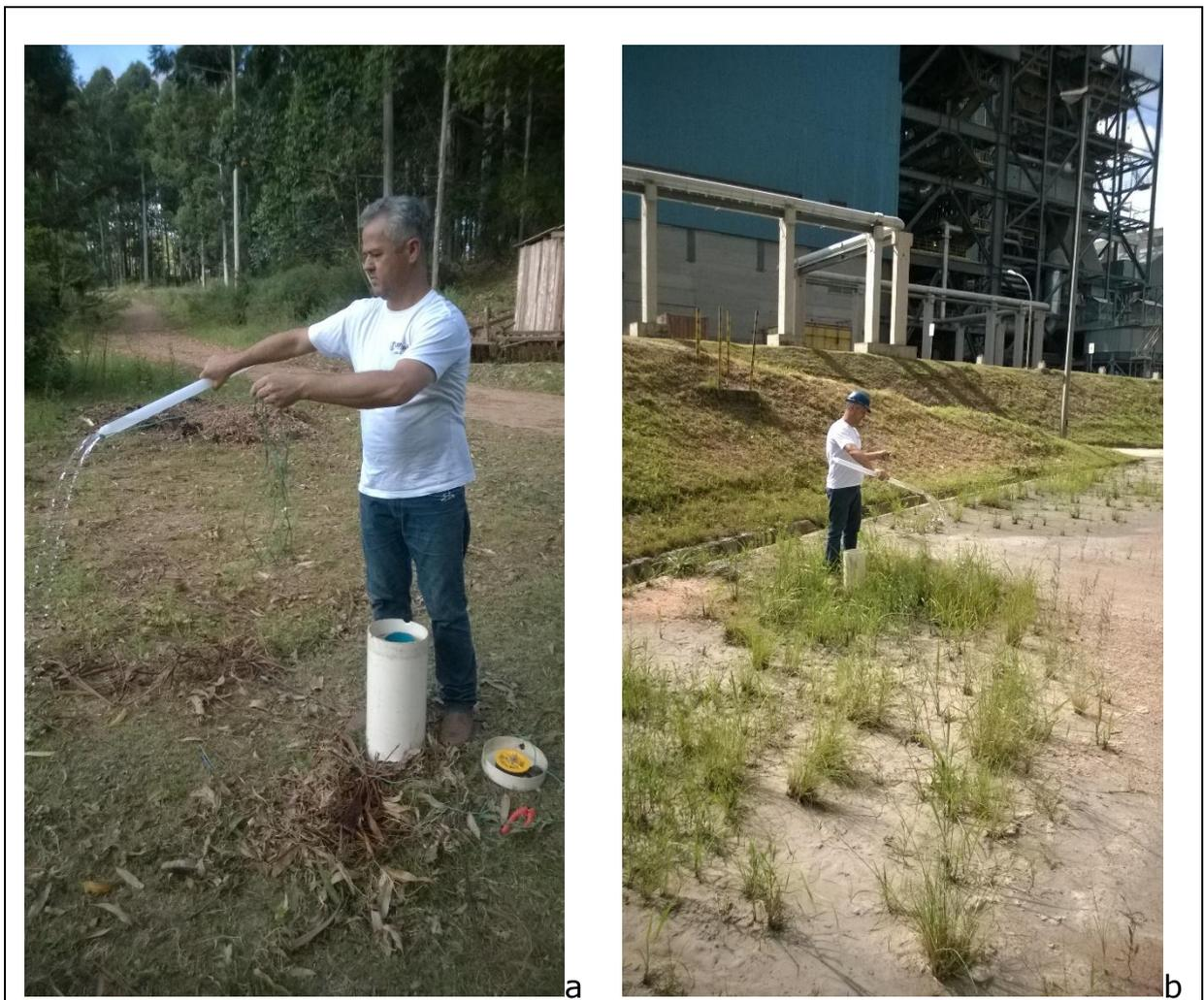
Figura 5. Esgotamento dos poços PM-5 (a) e PM-4 (b), realizado no dia 03 de fevereiro de 2015 com amostrador descartável tipo *beiler*. Note-se a ausência de turbidez na água de ambos os poços.
