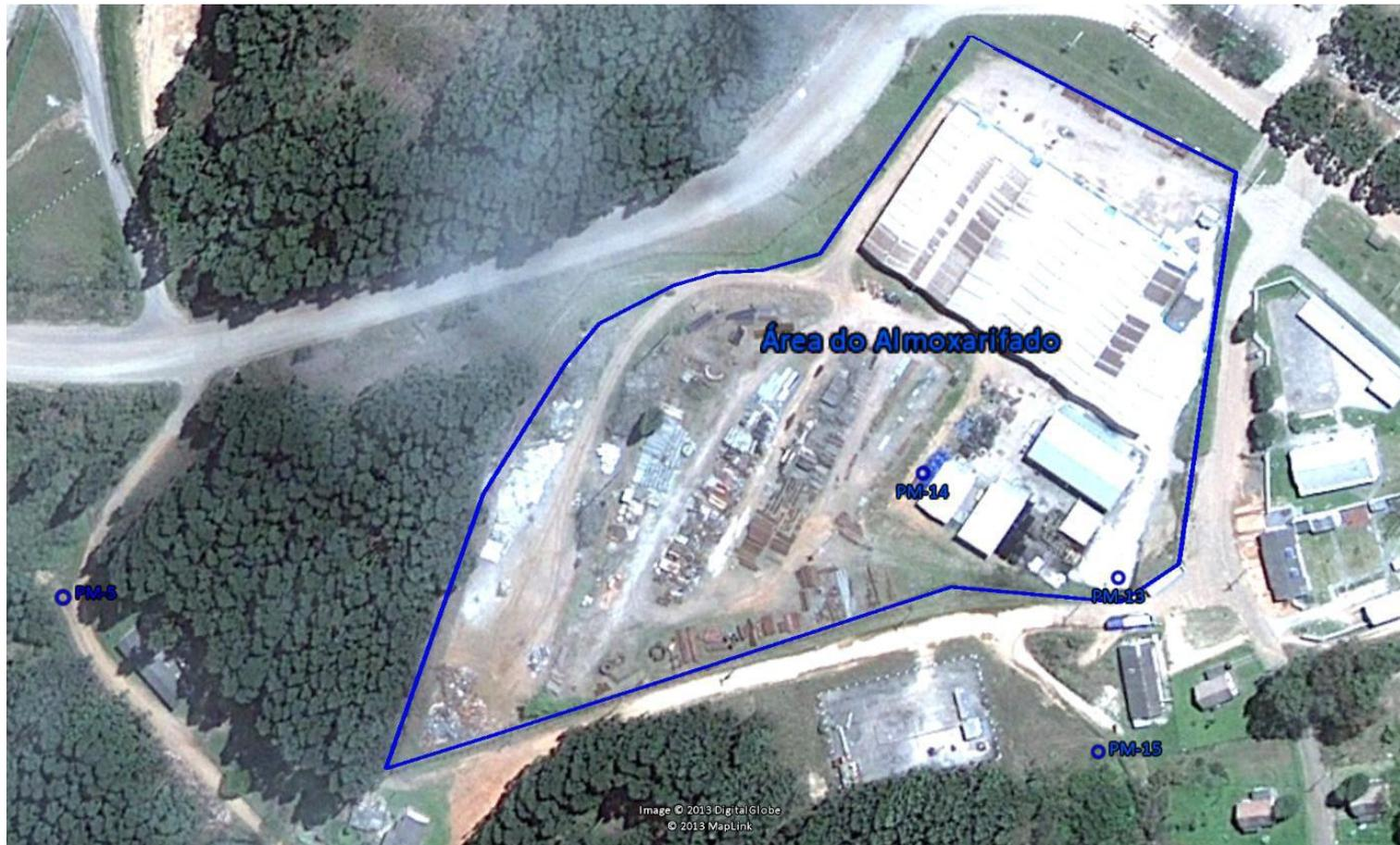
Figura 3. Localização dos poços de monitoramento da área do Almoxarifado. O poço PM-15 foi destruído por obras realizadas no local e excluído da rede de monitoramento.
