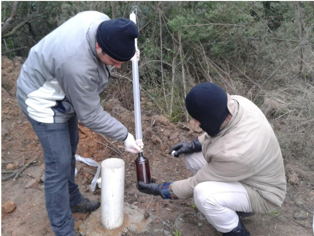
Figura 7. Coleta de amostra no poço PM-17 com amostrador descartável tipo beiler na primeira campanha de amostragem.
