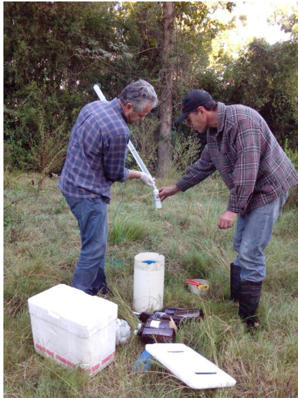
Figura 19. Coleta de amostra no poço PM-7 com amostrador descartável tipo beiler
