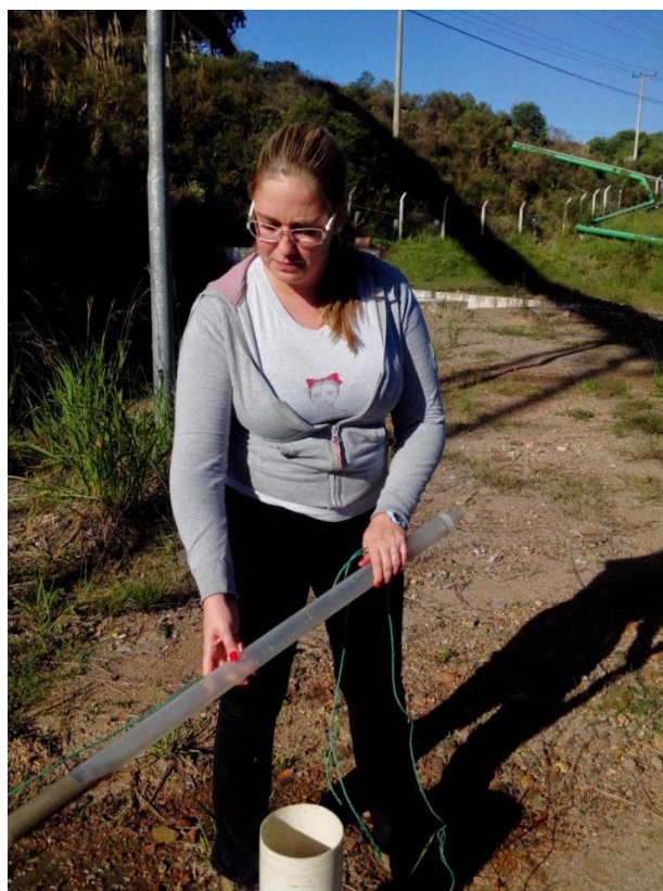
Figura 18. Esgotamento do poço PM-3 com amostrador descartável tipo beiler .
