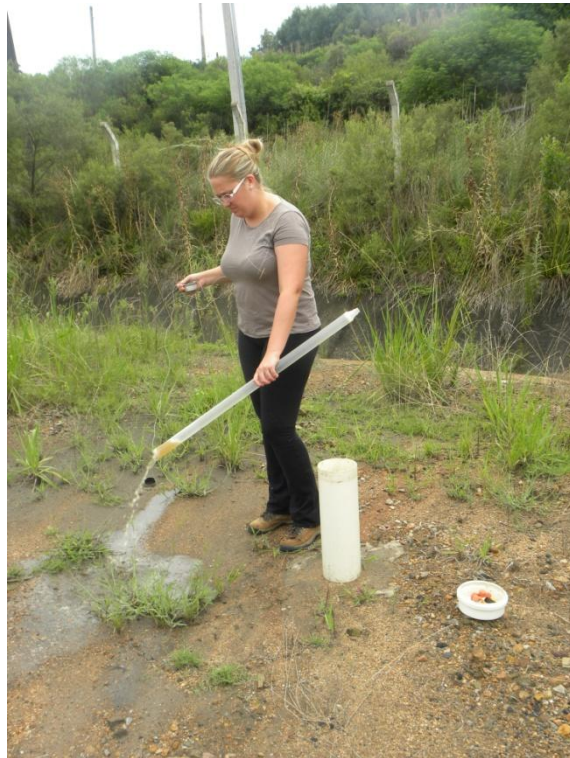
Figura 13. Esgotamento do poço PM-3 com amostrador descartável tipo beiler na terceira campanha de amostragem.
