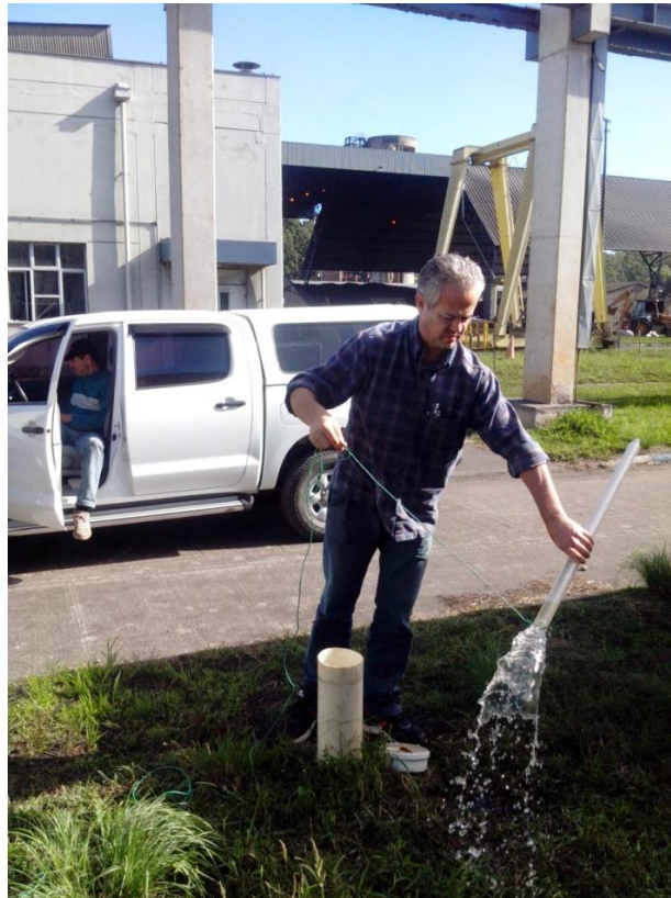
Figura 17. Esgotamento do poço PM-2 com amostrador descartável tipo beiler .
