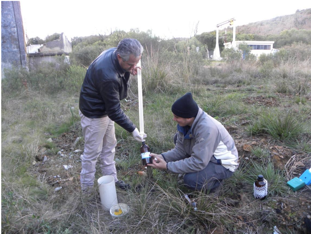
Figura 9. Coleta de amostra no poço PM-19 com amostrador descartável tipo beiler na primeira campanha de amostragem.
