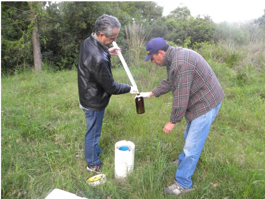
Figura 10. Coleta de amostra no poço PM-5 com amostrador descartável tipo beiler , na segunda campanha de amostragem.
