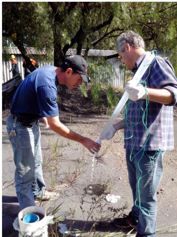
Figura 20. Coleta de amostra no poço PM-9 com amostrador descartável tipo beiler .
