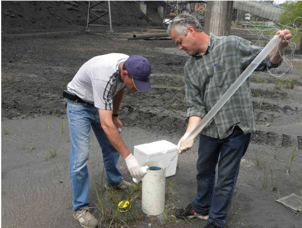
Figura 11. Coleta de amostra no poço PM-09 com amostrador descartável tipo beile na segunda campanha de amostragem.
