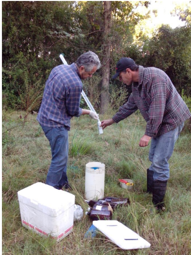
Figura 21. Coleta de amostra no poço PM-17 com amostrador descartável tipo beiler
