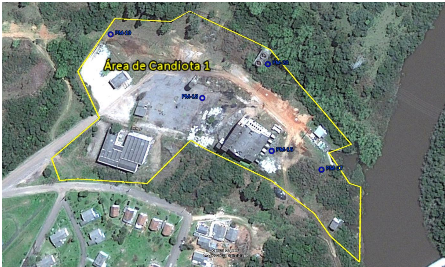
Figura 4. Localização dos poços de monitoramento da área de Candiotá 1. O poço PM-18 apresenta danos irreversíveis na sua estrutura causados por escavações realizadas nas suas imediações num período entre a terceira e quarta coleta, inutilizando-o para amostragens.
