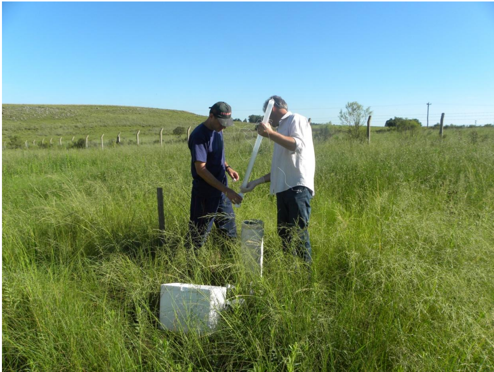
Figura 15. Coleta de amostra no poço PM-7 com amostrador descartável tipo beiler na terceira campanha de amostragem.
