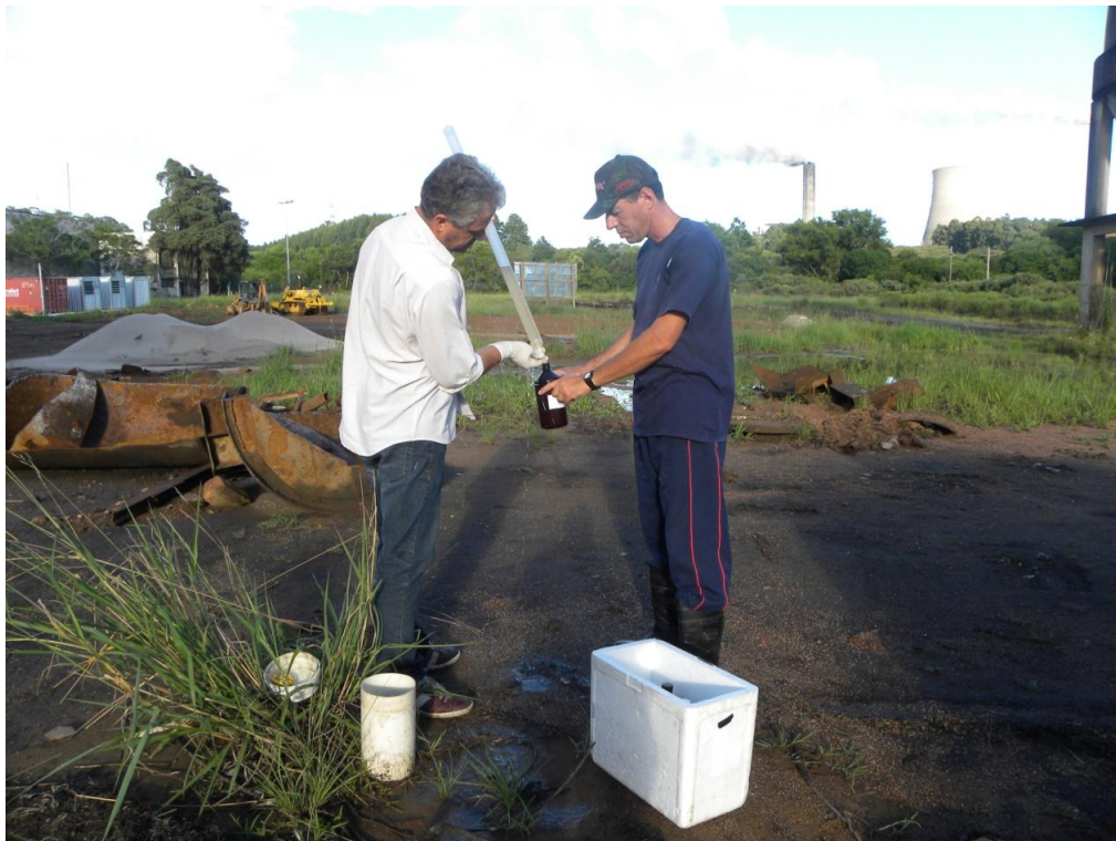
Figura 14. Coleta de amostra no poço PM-18 com amostrador descartável tipo beiler na terceira campanha de amostragem.
