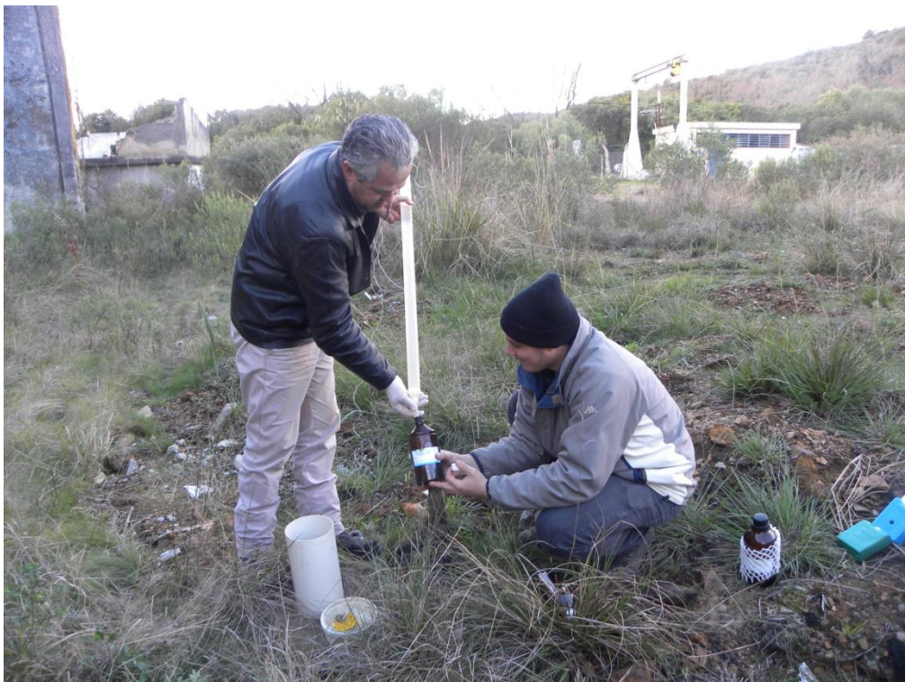
Figura 8. Coleta de amostra no poço PM-19 com amostrador descartável tipo beiler na primeira campanha de amostragem.
