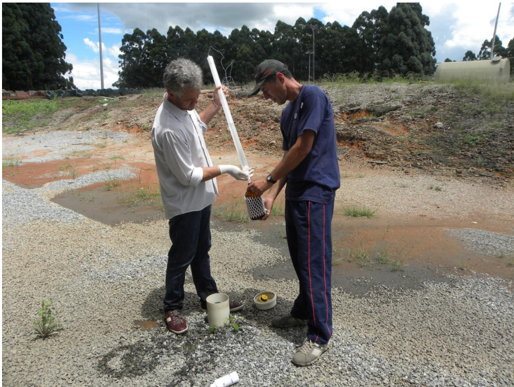
Figura 16. Coleta de amostra no poço PM-14 com amostrador descartável tipo beiler na terceira campanha de amostragem.
