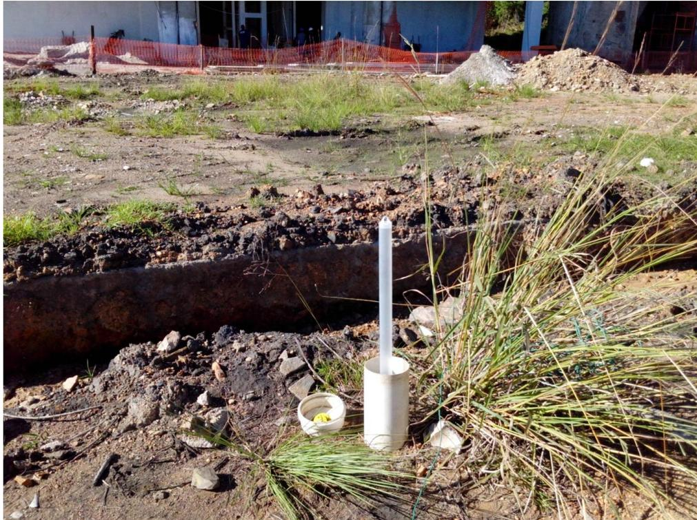
Figura 6. Fotografia mostrando o poço PM-18 e a escavação executada na sua imediação que danificou a estrutura do mesmo. Note que o amostrador pode ser introduzido somente até o ponto onde o tubo apresenta deslocamento lateral, impedindo a coleta de amostras.
