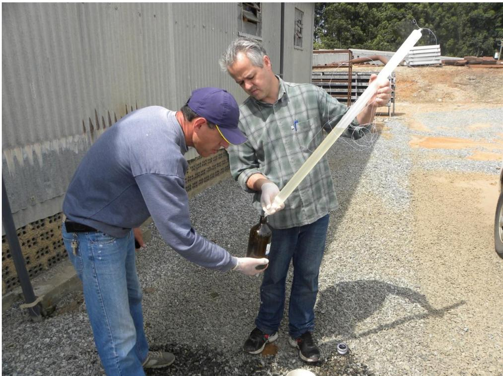
Figura 12. Coleta de amostra no poço PM-14 com amostrador descartável tipo *beiler* na segunda campanha de amostragem.
