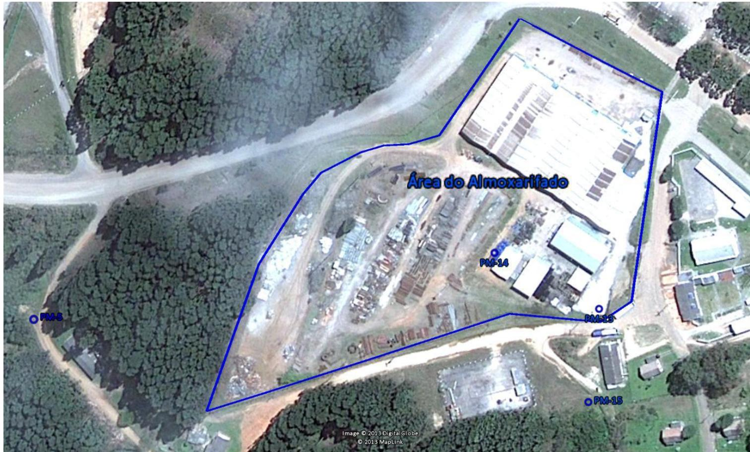
Figura 3. Localização dos poços de monitoramento da área do Almojarifado. O poço PM-15 foi soterrado por obras de terraplenagem realizadas no local num período entre a terceira e quarta coleta.
