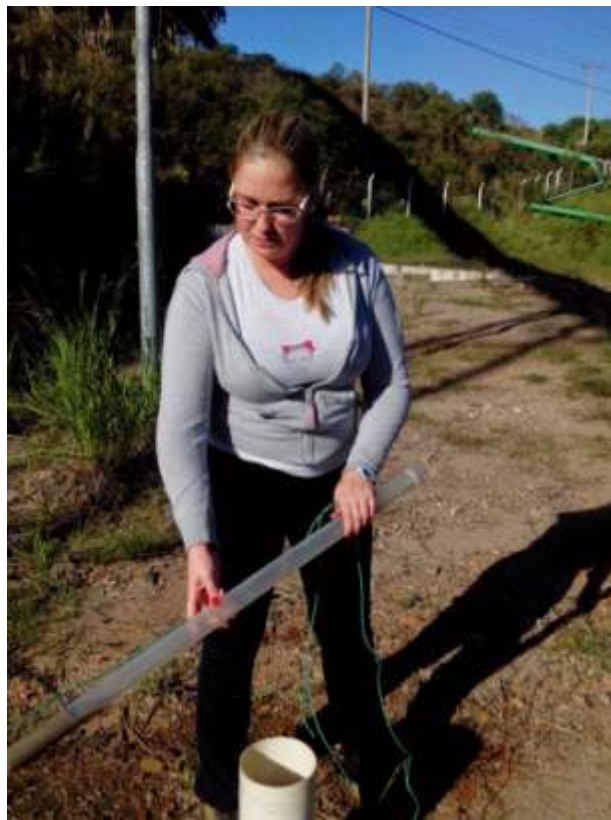
Figura 8. Esgotamento do poço PM-3 com amostrador descartável tipo beiler .
