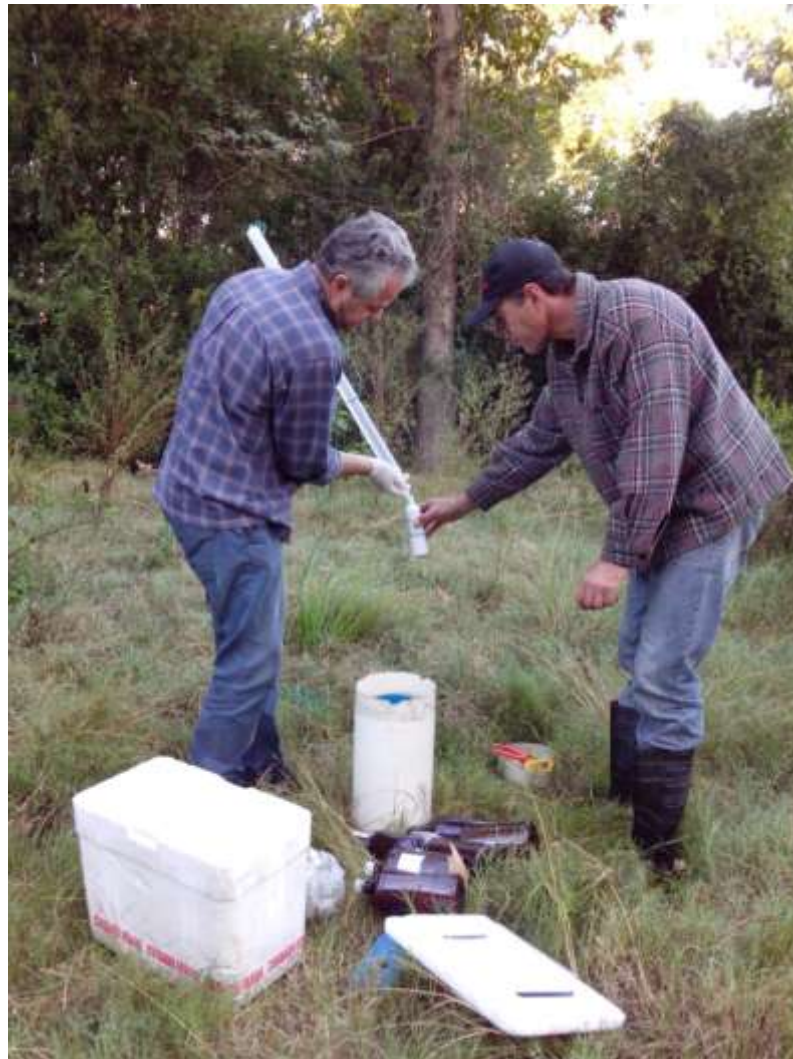
Figura 11. Coleta de amostra no poço PM-17 com amostrador descartável tipo beiler
