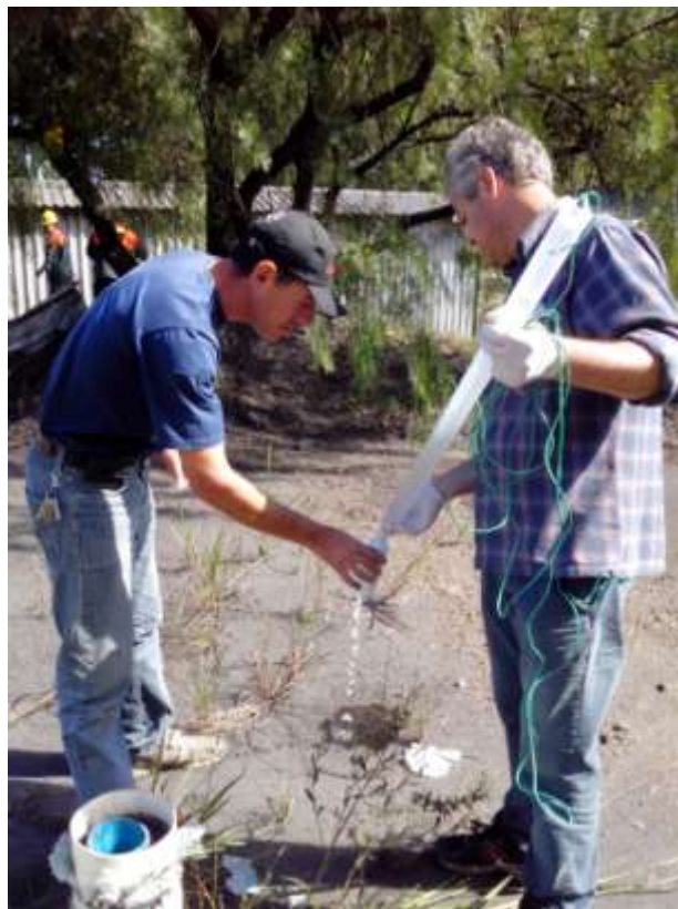
Figura 10. Coleta de amostra no poço PM-9 com amostrador descartável tipo beiler .
