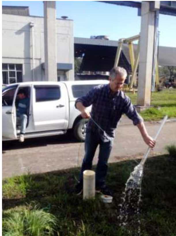
Figura 7. Esgotamento do poço PM-2 com amostrador descartável tipo beiler .
