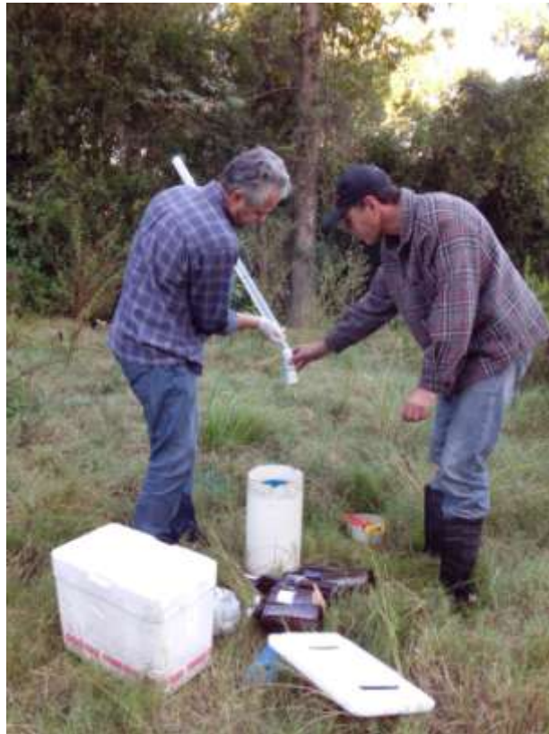
Figura 9. Coleta de amostra no poço PM-7 com amostrador descartável tipo beiler
