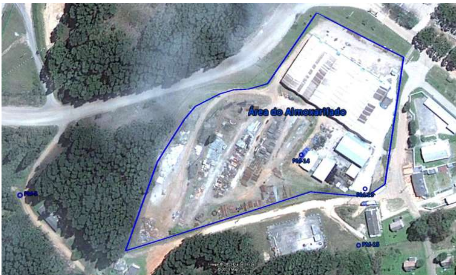
Figura 3. Localização dos poços de monitoramento da área do Almoarifado. O poço PM-15 foi soterrado por obras de terraplenagem realizadas no local.
