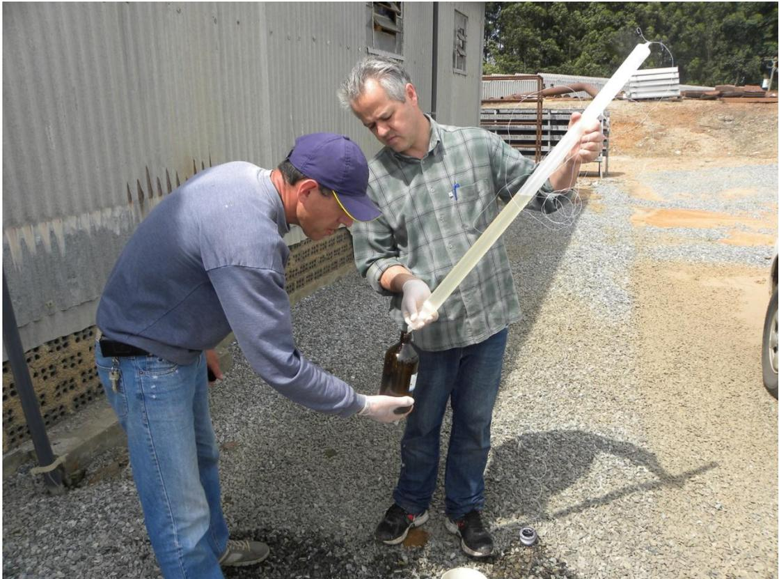
Figura 7. Coleta de amostra no poço PM-14 com amostrador descartável tipo *beiler*
