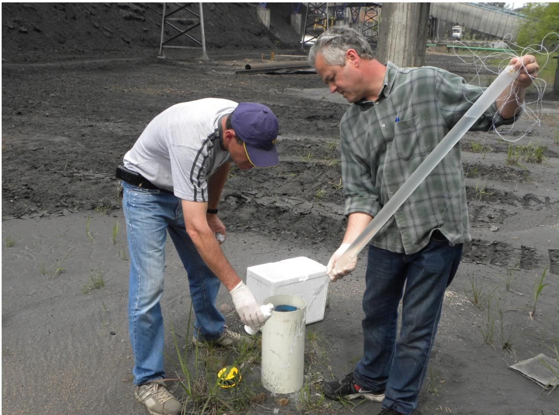
Figura 8. Coleta de amostra no poço PM-09 com amostrador descartável tipo *beiler*
