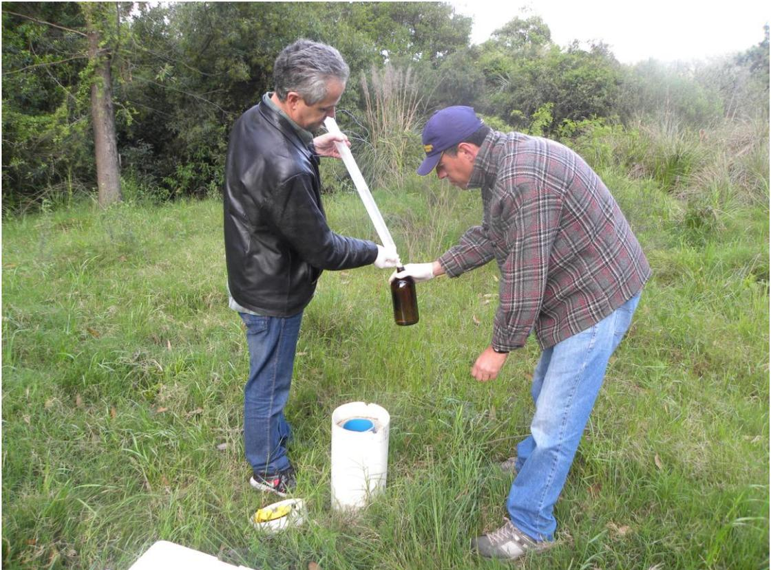
Figura 5. Coleta de amostra no poço PM-5 com amostrador descartável tipo *beiler*.
