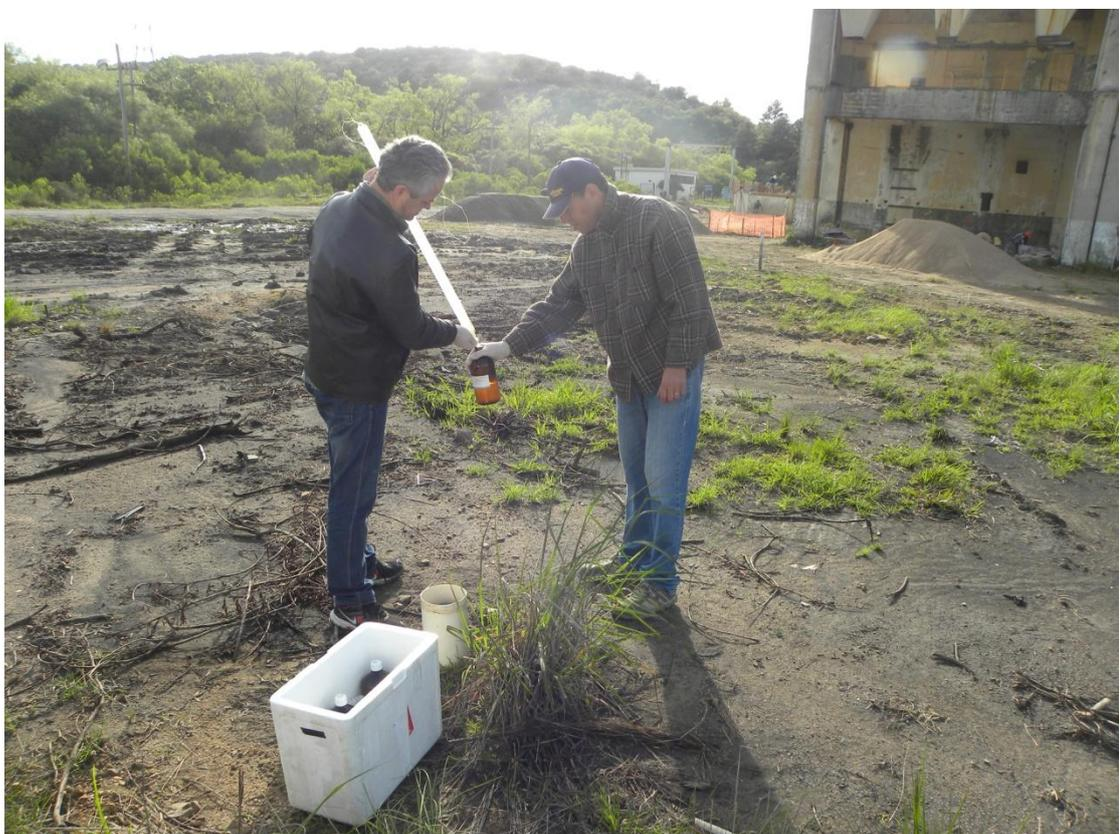
Figura 6. Coleta de amostra no poço PM-18 com amostrador descartável tipo *beiler*.
