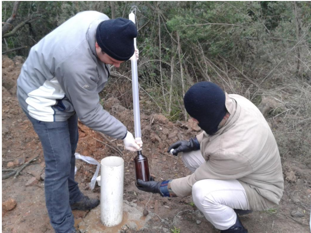
Figura 4. Coleta de amostra no poço PM-17 com amostrador descartável tipo beiler .
