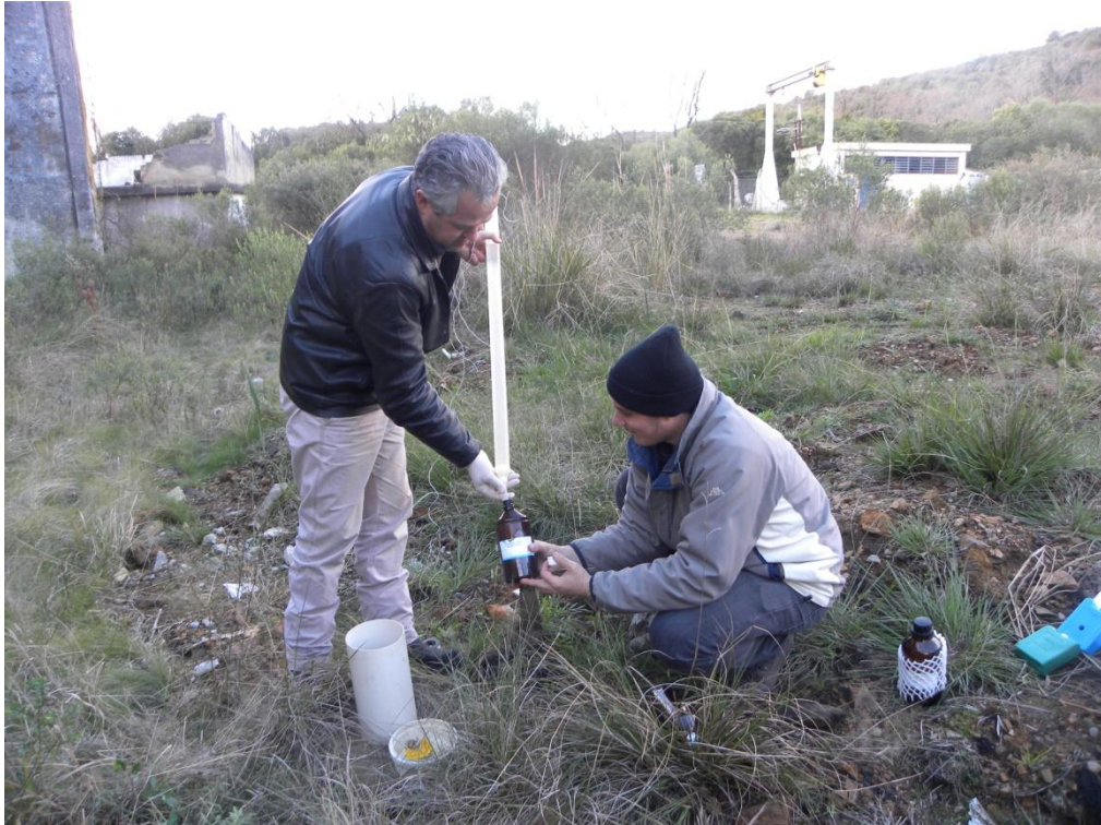
Figura 6. Coleta de amostra no poço PM-19 com amostrador descartável tipo beiler
