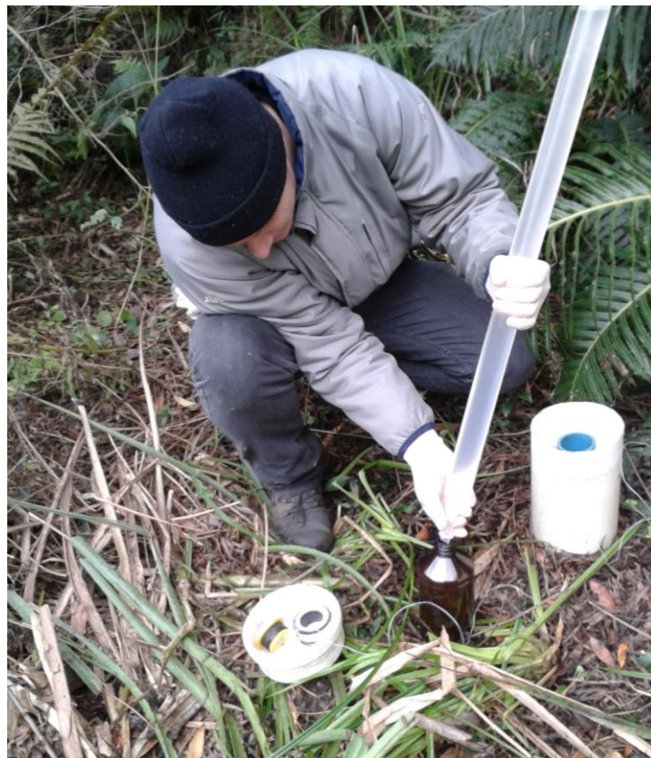
Figura 5. Coleta de amostra no poço PM-20 com amostrador descartável tipo beiler .
