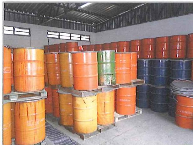
**Figura 3 – Acondicionamento de resíduos de Toalha Mecânica Usada e Óleo Combustível.**
