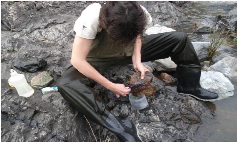
Figura 2.4.2. Ilustração com a raspagem das pedras para a coleta de organismos do Perifiton.
