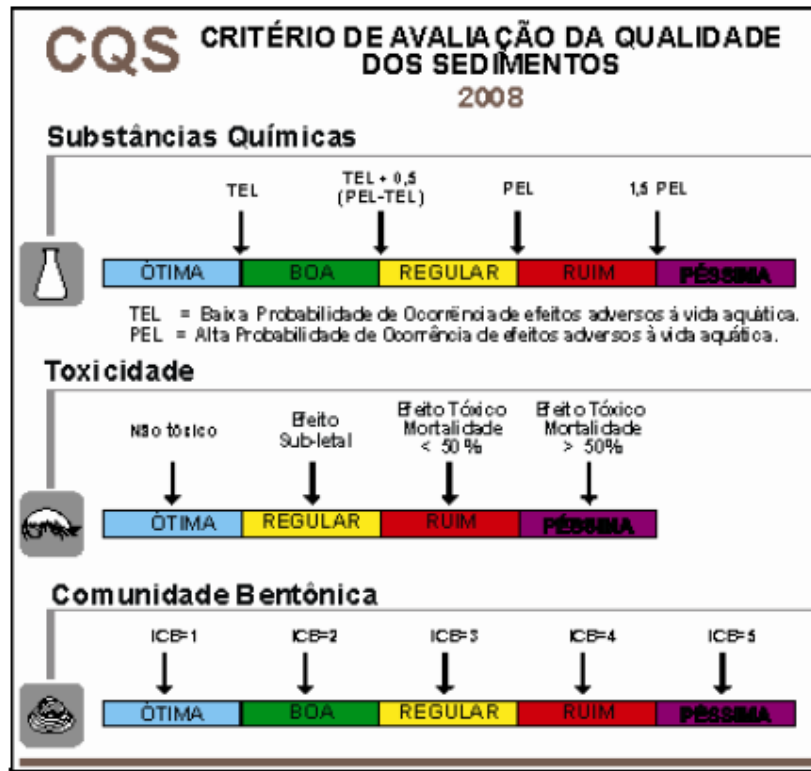
Figura 5.1 – Resumem-se os elementos que compõe os critérios de avaliação da Qualidade dos sedimentos da CETESB utilizando as análises químicas nos sedimentos, a toxicidade e a comunidade betônica. Modificado de CETESB (2007).
