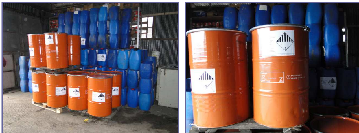
Figura 5 – Acondicionamento e armazenamento temporário de resíduos perigosos de varrição e bombonas vazias.
