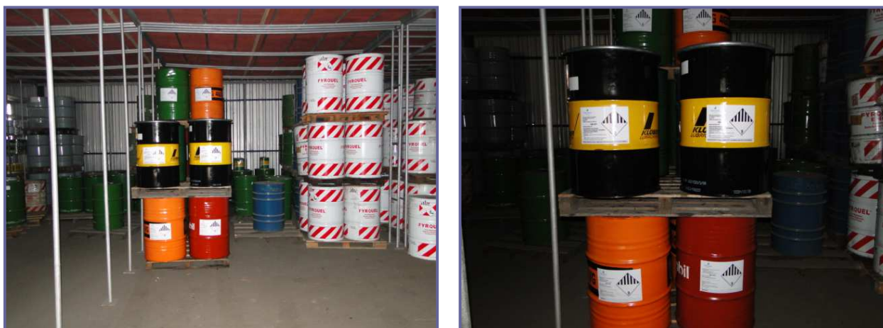
Figura 3 – Acondicionamento e armazenamento temporário de óleo lubrificante usado.
