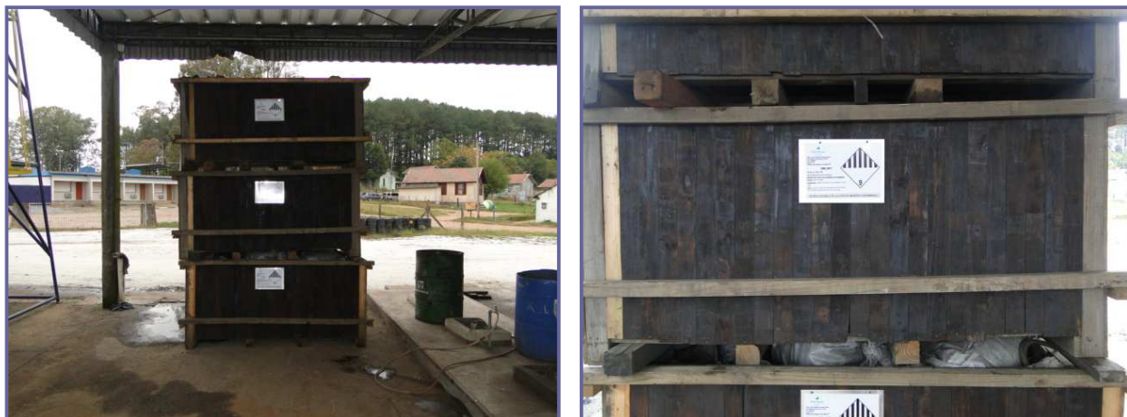
Figura 2 – Acondicionamento e armazenamento temporário de toalhas mecânicas em local coberto.
