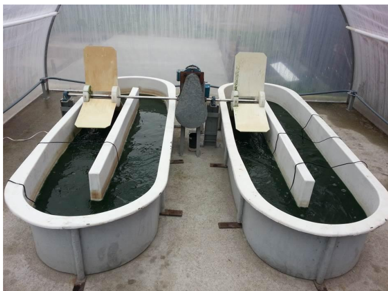
Figura 65: Propagação do inóculo de Spirulina na estufa de cultivo microalgal da FURG
