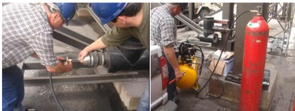
Figura 16: Montagem do sistema de captação – Técnicos do Laboratório Roque L. Zilio e Adriano Arruda Henrard
