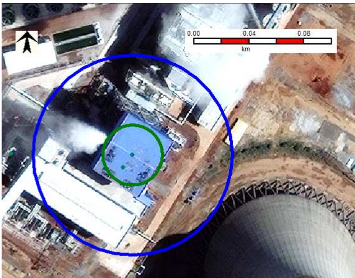
Figura 3.8- Incêndio em poça de óleo combustível, na área da fornalha da Fase C, Cenário 12C, alcances para fluxos térmicos de 3 kW/m 2 (azul) e 12,5 kW/m 2 (verde)
