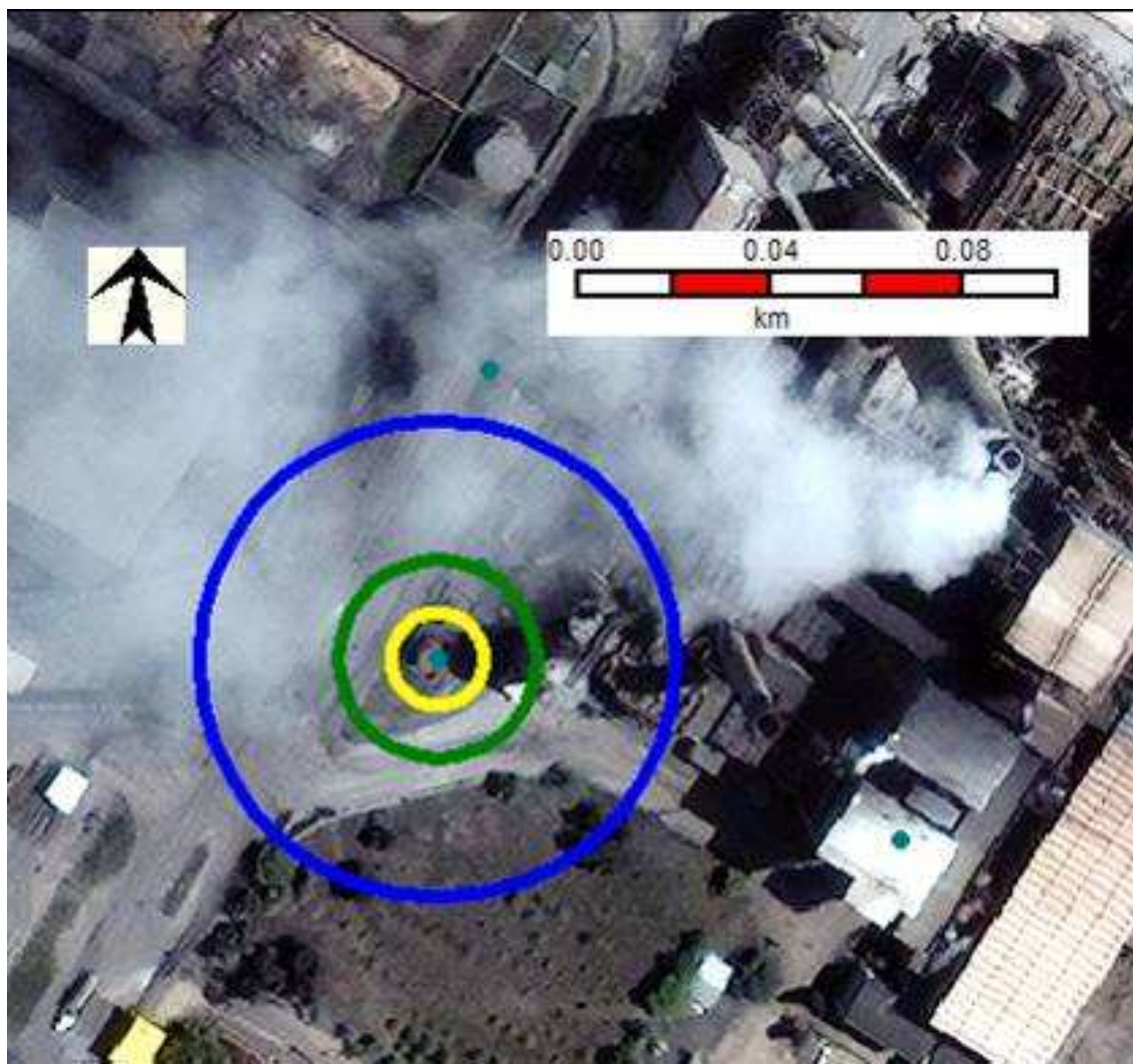
Figura 3.3 - Incêndio em poça de combustível, no dique do tanque de 125 \text{ m}^3 da Fase A, Hipótese 17A, alcances para fluxos térmicos de 3 \text{ kW/m}^2 (azul), 12,5 \text{ kW/m}^2 (verde) e 37,5 \text{ kW/m}^2 (amarelo)
