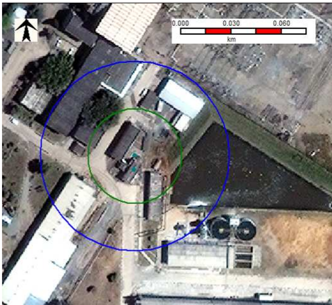
Figura 3.10- Explosão de nuvem de hidrogênio e ar, ruptura de cilindro, Hipótese 5ABC, alcances para sobrepressões de 0,1 bar (verde) e 0,05 bar (azul)
