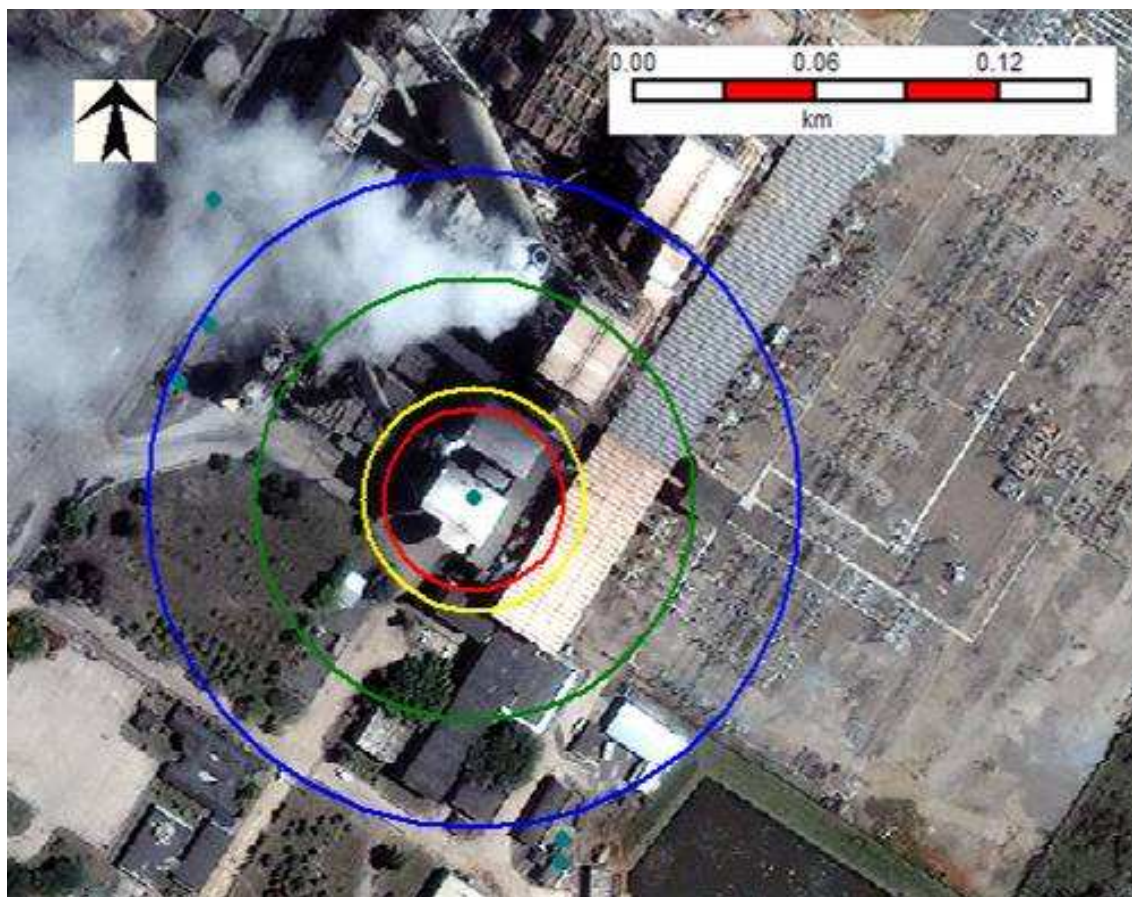
Figura 3.13- Explosão por expansão de vapor de água (BLEVE) da caldeira da Fase A, Hipótese 29Aa, alcances para sobrepressões de 0,43 bar (vermelho), 0,3 bar (amarelo), 0,1 bar (verde) e 0,05 bar (azul)
