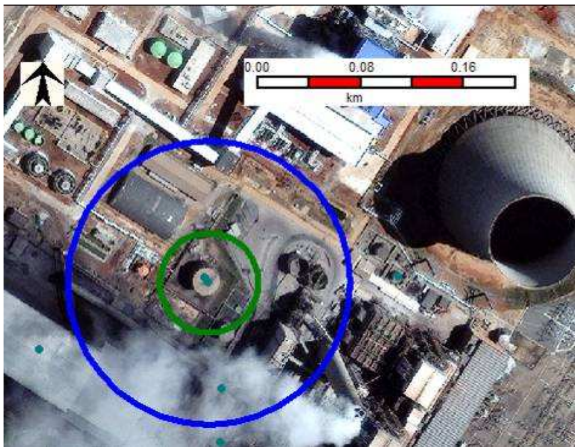
Figura 3.5- Incêndio em poça de combustível 1A, no dique do tanque de 5000 m 3 , Hipótese 14 ABC, alcances para fluxos térmicos de 3 kW/m 2 (azul) e 12,5 kW/m 2 (verde)
