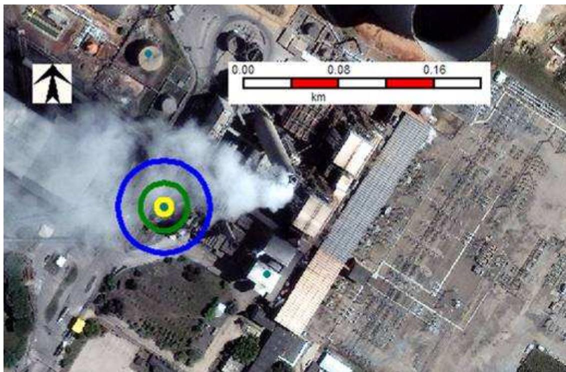
Figura 3.2- Incêndio em poça de diesel, no dique do tanque de 55 m 3 da Fase A, Hipótese 8A, alcances para fluxos térmicos de 3 kW/m 2 (azul), 12,5 kW/m 2 (verde) e 37,5 kW/m 2 (amarelo)
