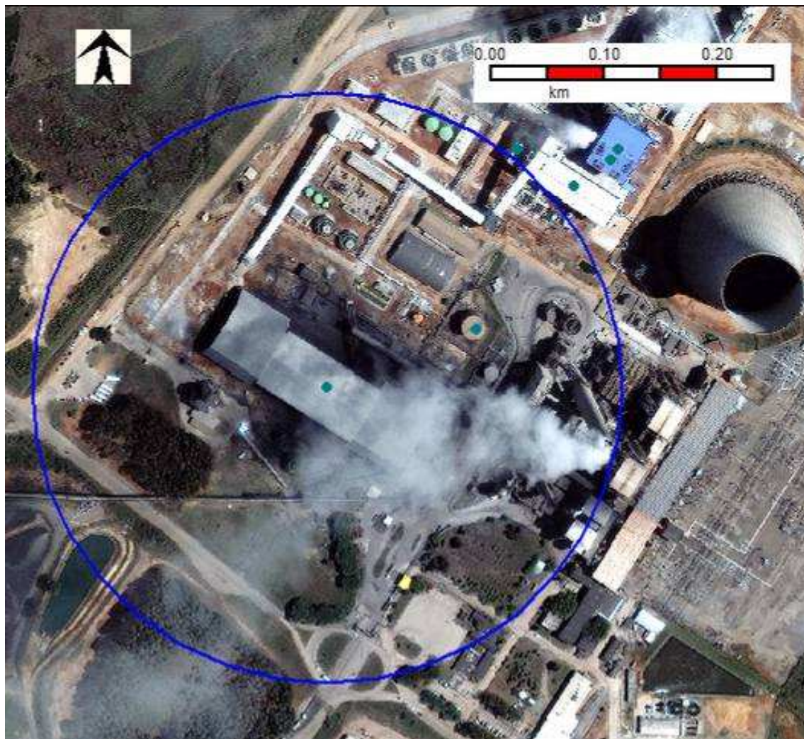
Figura 3.16- Explosão de nuvem de pó de carvão e ar, no pátio de carvão, Cenário 1ABC, alcances para sobrepressões de 0,1 bar (verde) e 0,05 bar (azul)
