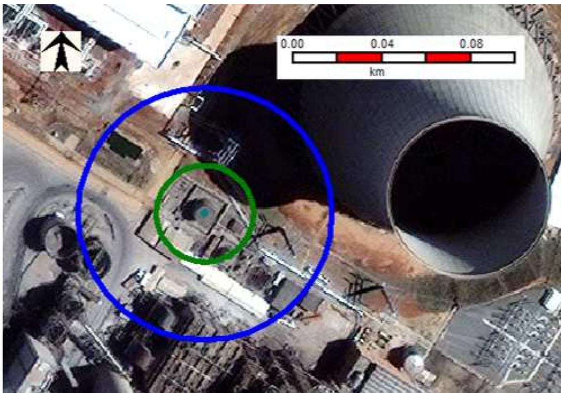
**Figura 6.11- Incêndio em poça de óleo combustível, no dique do tanque de 500 m<sup>3</sup> da Fase B, Hipótese 20B, alcance para fluxos térmicos de 3 kW/m<sup>2</sup> (azul) e 12,5 kW/m<sup>2</sup> (verde)**
