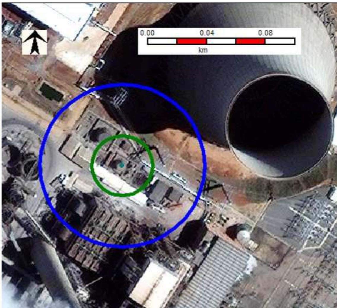
**Figura 6.6- Incêndio em poça de diesel, no dique do tanque de 200 m<sup>3</sup> da Fase B, Hipótese 11 B, alcan-
