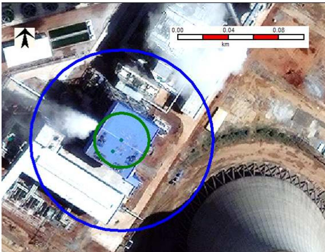
Figura 6.16- Incêndio em poça de óleo combustível, na área da fornalha da Fase C, Cenário 12C, alcances para fluxos térmicos de  $3 \text{ kW/m}^2$  (azul) e  $12,5 \text{ kW/m}^2$  (verde)
