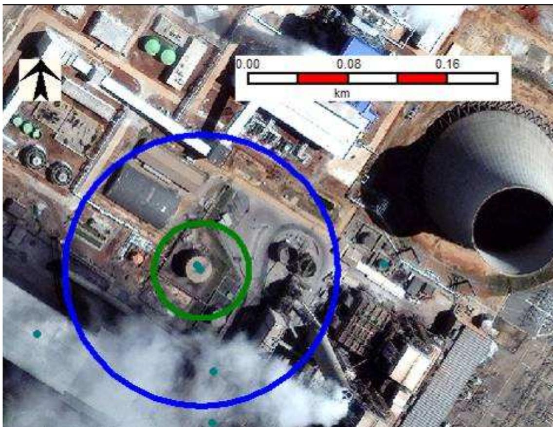
Figura 6.8- Incêndio em poça de combustível 1A, no dique do tanque de 5000 m<sup>3</sup>, Hipótese 14 ABC, alcances para fluxos térmicos de 3 kW/m<sup>2</sup> (azul) e 12,5 kW/m<sup>2</sup> (verde)
