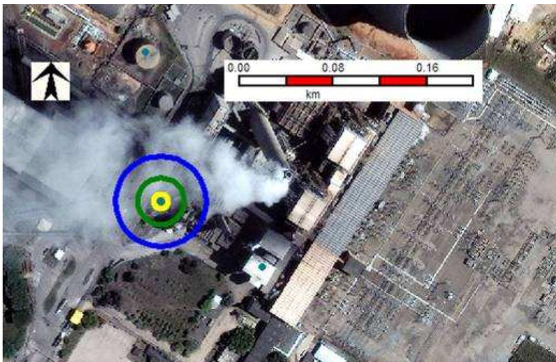
Figura 6.5- Incêndio em poça de diesel, no dique do tanque de 55 m<sup>3</sup> da Fase A, Hipótese 8A, alcances para fluxos térmicos de 3 kW/m<sup>2</sup> (azul), 12,5 kW/m<sup>2</sup> (verde) e 37,5 kW/m<sup>2</sup> (amarelo)
