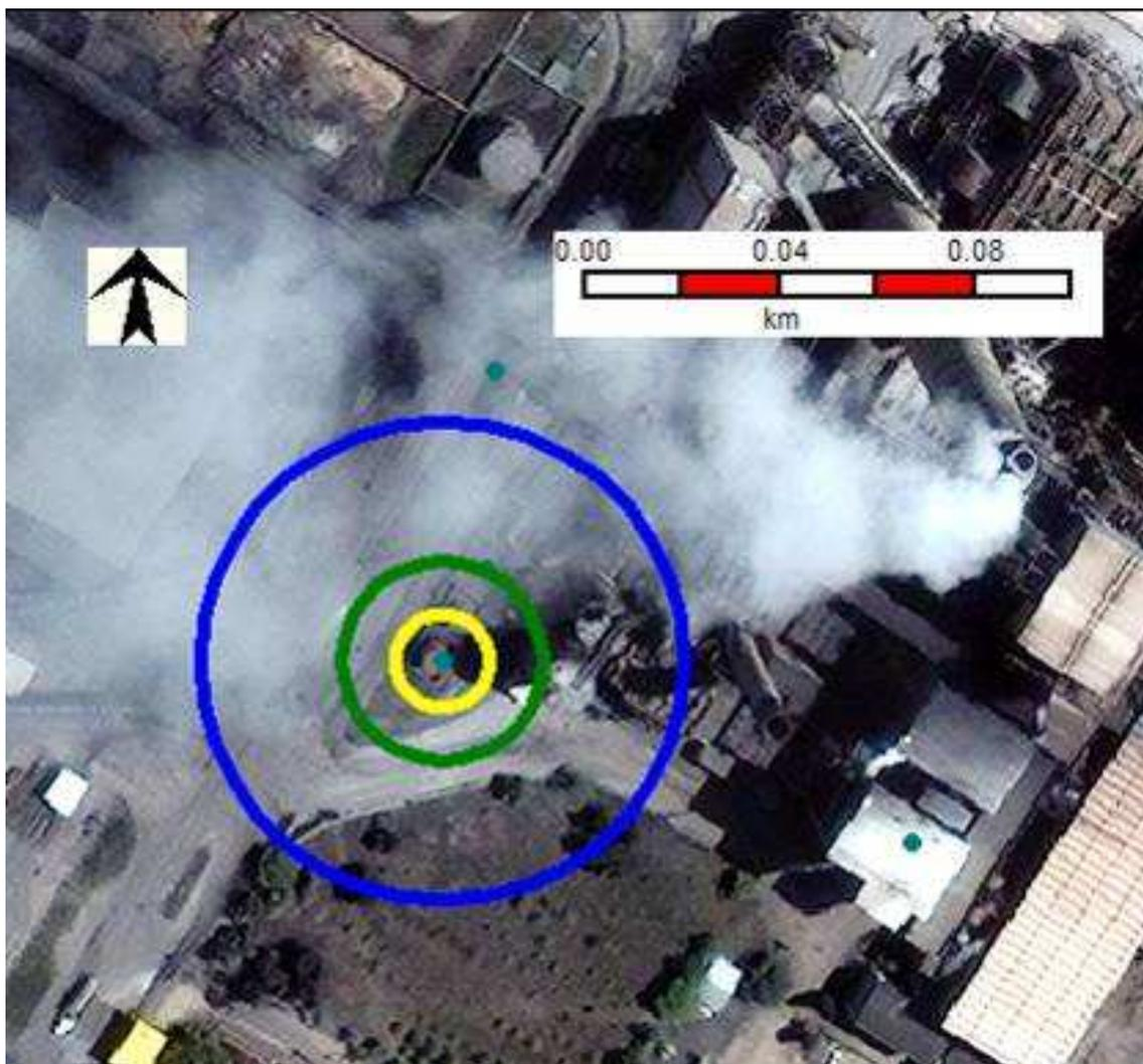
**Figura 6.10 - Incêndio em poça de combustível, no dique do tanque de 125 m<sup>3</sup> da Fase A, Hipótese 17A, alcances para fluxos térmicos de 3 kW/m<sup>2</sup> (azul), 12,5 kW/m<sup>2</sup> (verde) e 37,5 kW/m<sup>2</sup> (amarelo)**
