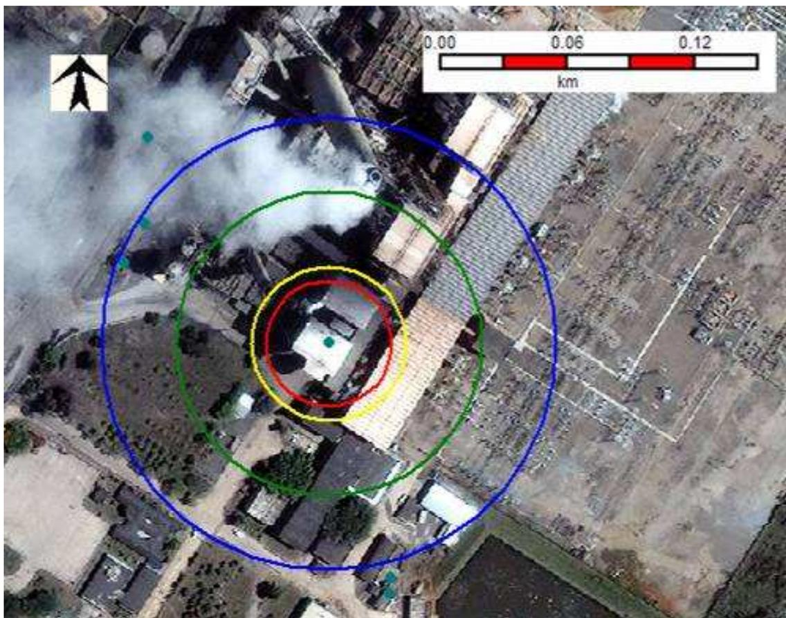
**Figura 6.13- Explosão por expansão de vapor de água (BLEVE) da caldeira da Fase A, Hipótese 29Aa, alcances para sobrepressões de 0,43 bar (vermelho), 0,3 bar (amarelo), 0,1 bar (verde) e 0,05 bar (azul)**
