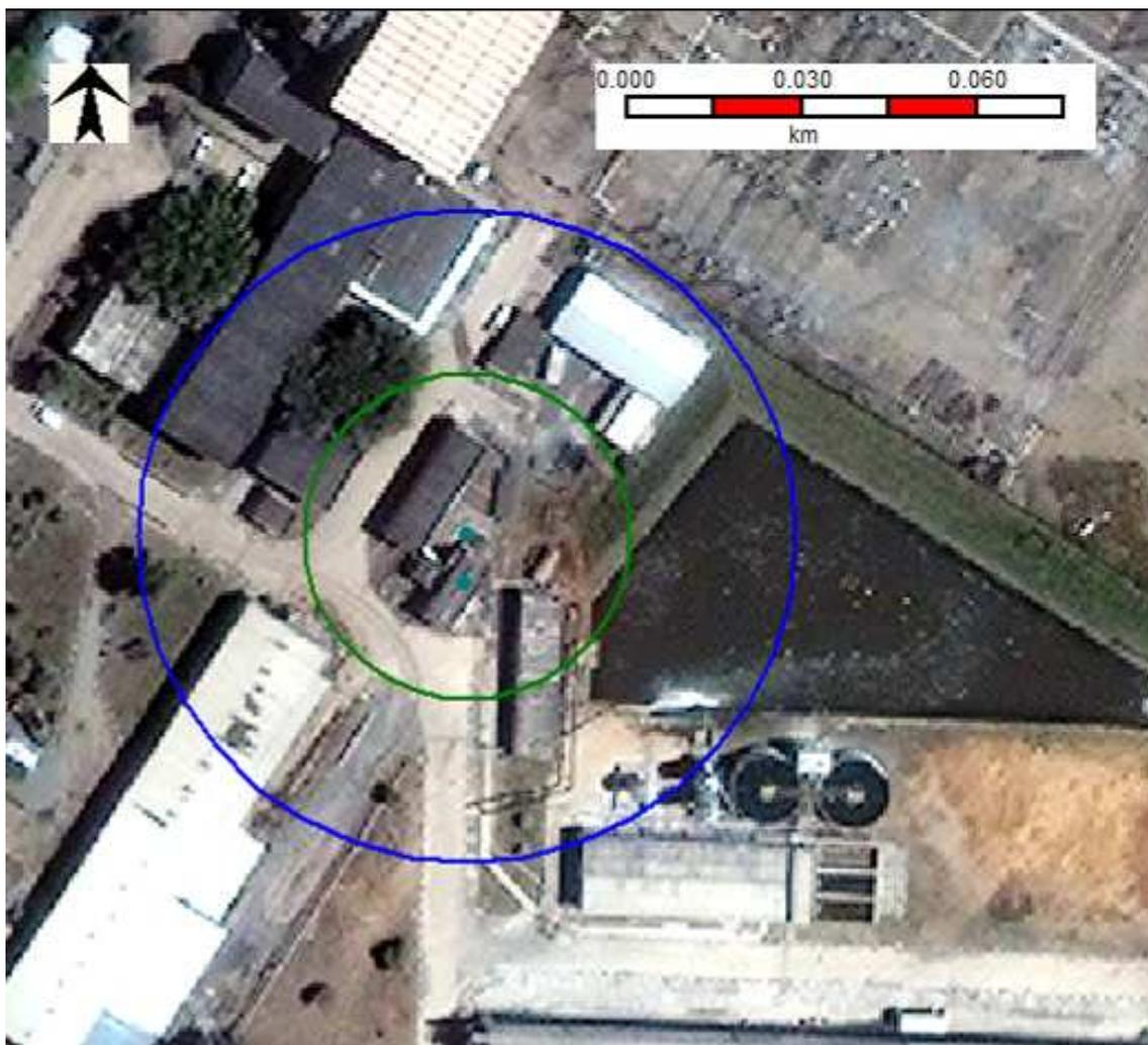
**Figura 6.3- Explosão de nuvem de hidrogênio e ar, ruptura de cilindro, Hipótese 5ABC, alcances para sobrepressões de 0,1 bar (verde) e 0,05 bar (azul)**
