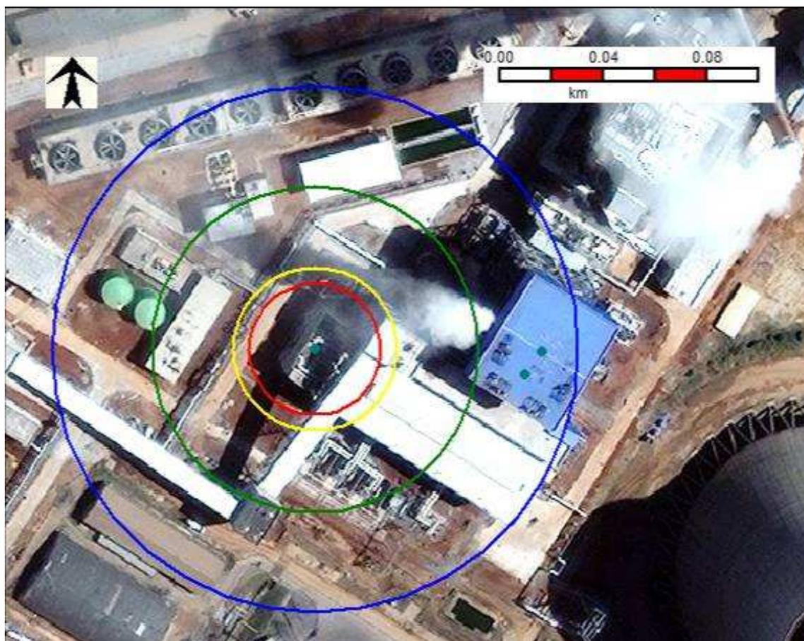
**Figura 6.20- Explosão confinada de hidrogênio e ar, Cenário 64C, na sala de baterias, alcances para sobrepressões de 0,43 bar (vermelho), 0,3 bar (amarelo), 0,1 bar (verde) e 0,05 bar (azul)**
