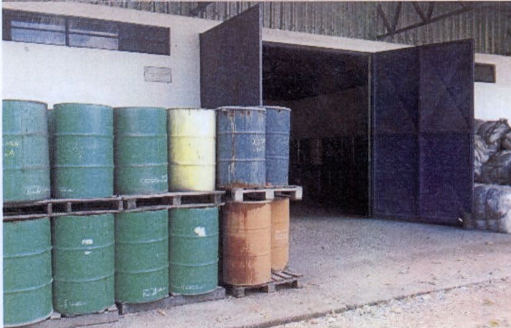
Figura 51: Tambores com resíduos classe I (resina usada) acondicionados fora da área da central destinada para resíduos perigosos
