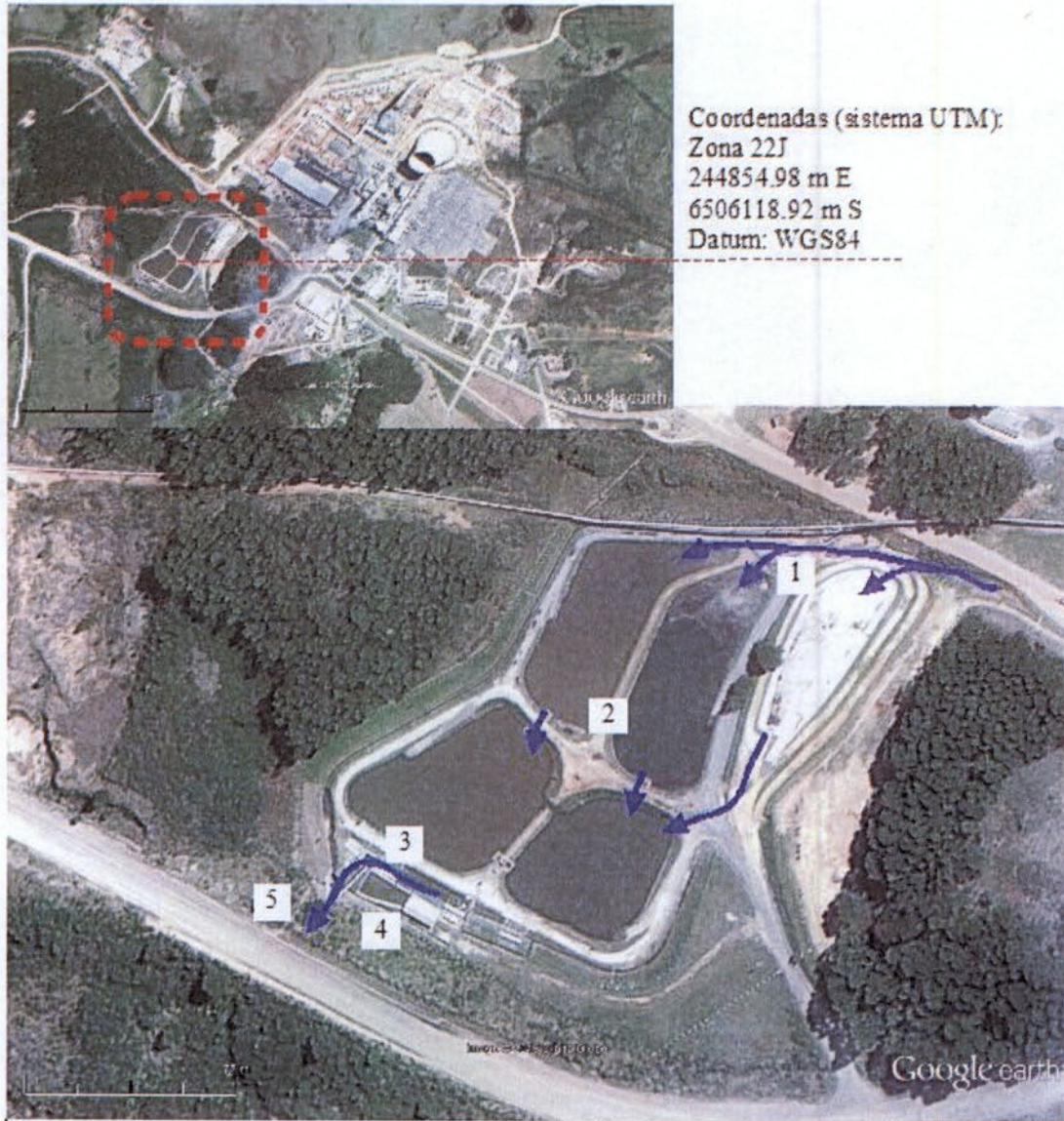
Figura 1. Localização do sistema de bacias de sedimentação, pontos vistoriados e indicação do fluxo dos efluentes
