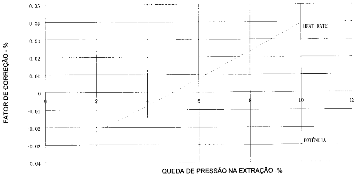
CORREÇÃO DEVIDO À QUEDA DE PRESSÃO NO PRÉ-AQUECEDOR DE ALTA PRESSÃO Nº4
