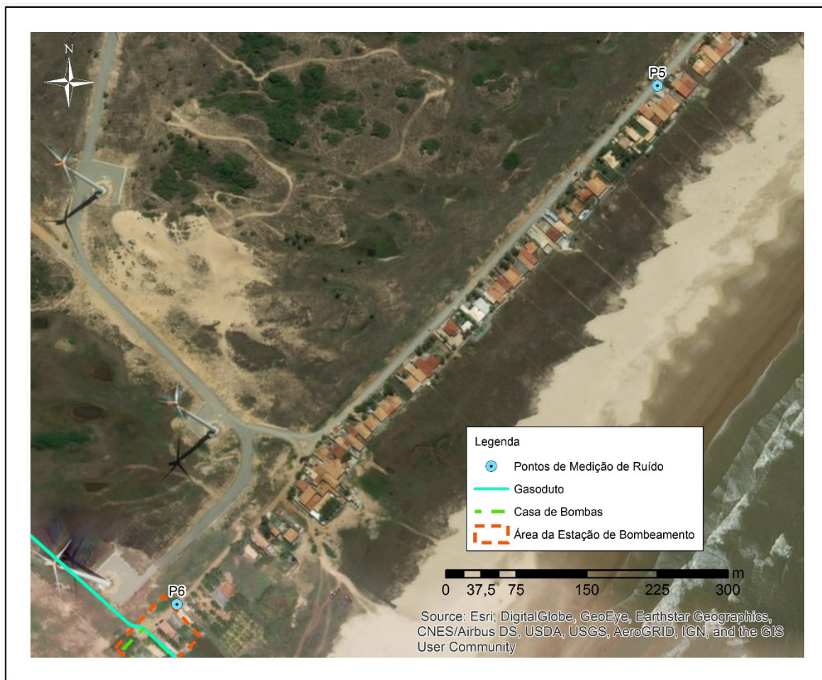
Figura 4: Localização dos pontos de medição de ruído nas imediações do canteiro de obras
