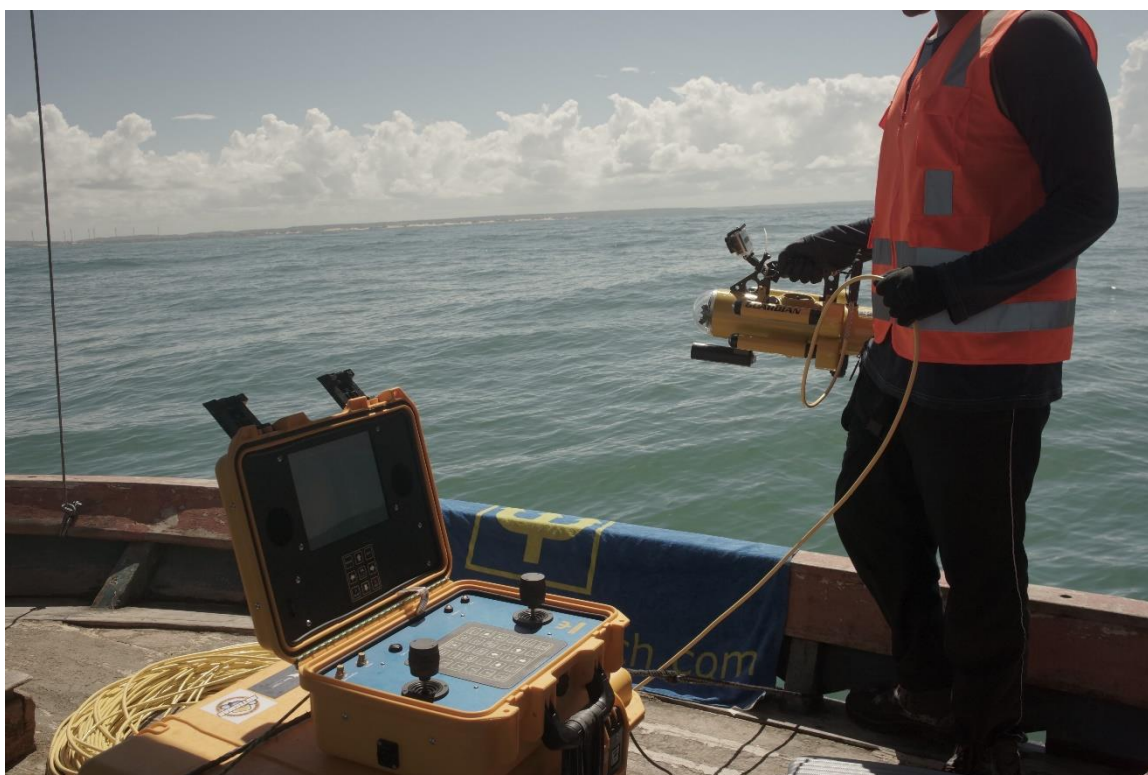
Figura 2: Micro-ROV utilizado nas campanhas.
