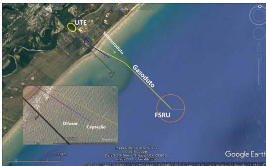
Figura 3-4: Arranjo FSRU, gasoduto e UTE da Alternativa 3
