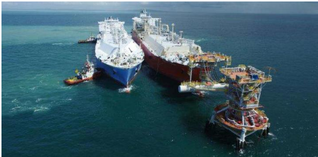
Foto 5-2: Operação de atracação a contrabordo de navio metaneiro a uma FSRU ancorada a um yoke em torre
