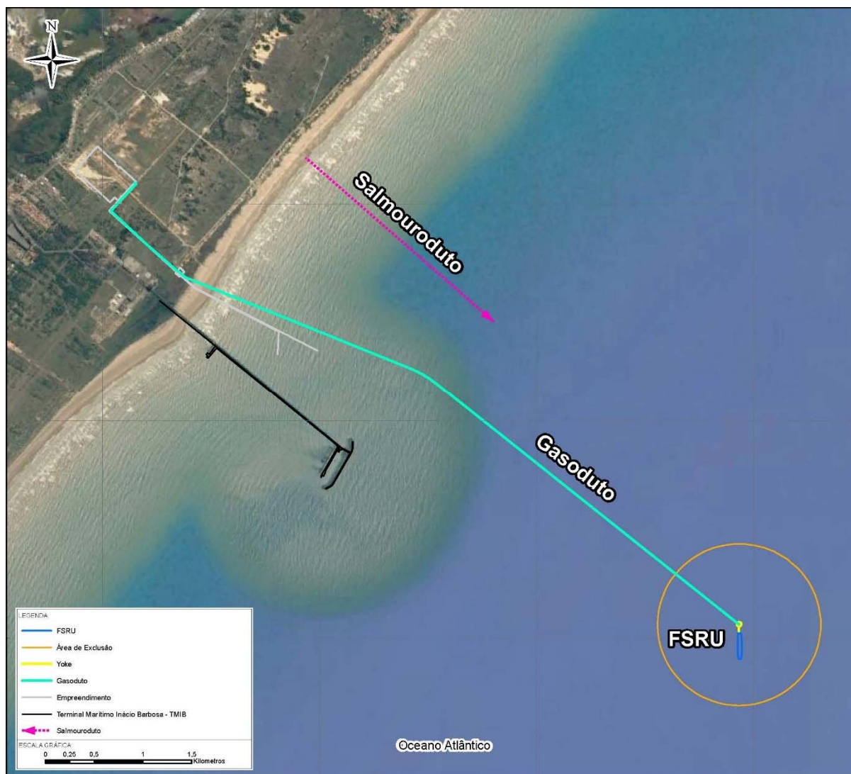
Figura 3-4: Arranjo FSRU, gasoduto e UTE da Alternativa 3
