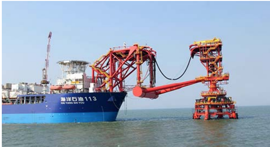
Foto 3-3: Sistema de Ancoragem em Torre
