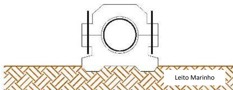
Figura 5-16: Seção transversal ilustrativa do trecho final, onde os dutos serão assentados sobre o leito marinho
