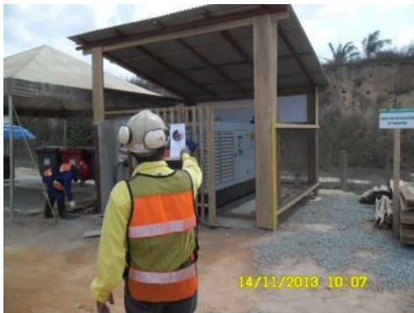
Foto 2-67: Realização de monitoramento Ringelmann de fontes estacionárias (grupo gerador); (Locação 20).
