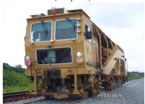
Foto 2-18: Máquina socadora de lastro da superestrutura (Locação 36-37).
