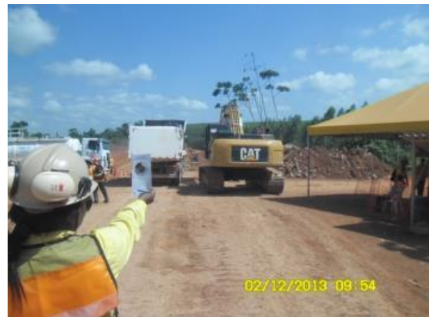
Foto 2-68: Monitoramento Ringelmann das fontes móveis a cada 500 horas de trabalho executado (Locação 30).
