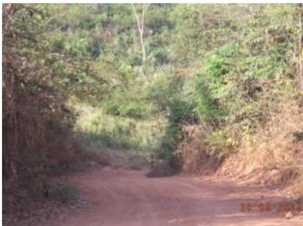
Foto 23: Trecho com inclinação acentuada antecedendo curva. Ausência de sinalização. Fonte: Amplo, 2013.
