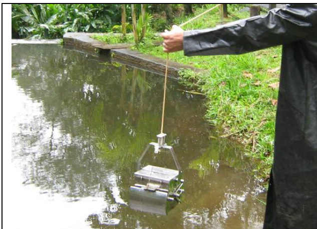
Foto 01: Draga Ekman-Birge utilizada na coleta de zoobentos.
