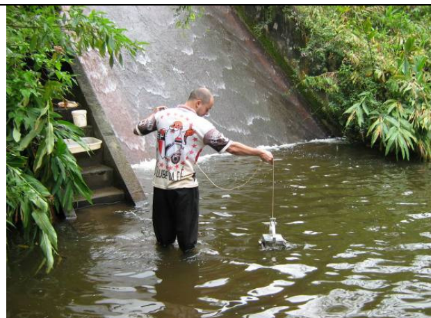
Foto 02: Utilização de draga Ekman-Birge para coleta de zoobentos.
