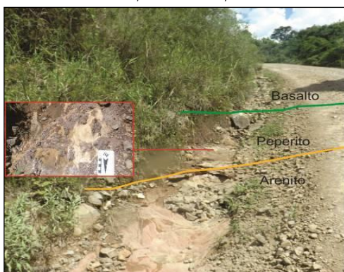
Foto 28. Contato entre arenito e basalto, em detalhe, brecha peperítica. Coord.: -29,557079° e -54,156353°.
