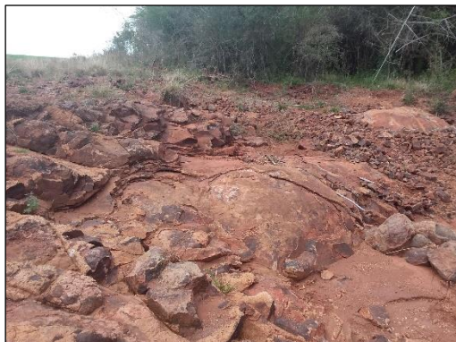
Foto 90. Rocha com esfoliação esferoidal e grau de coerência R3. Coord.: -28,951697° e -54,312698°.
