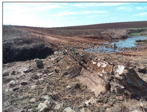
Foto 87. Rocha ácida com grau de coerência R5. Salienta-se a presença dos planos de estratificação da rocha. Coord.: -29,153950° e -54,268417°.
