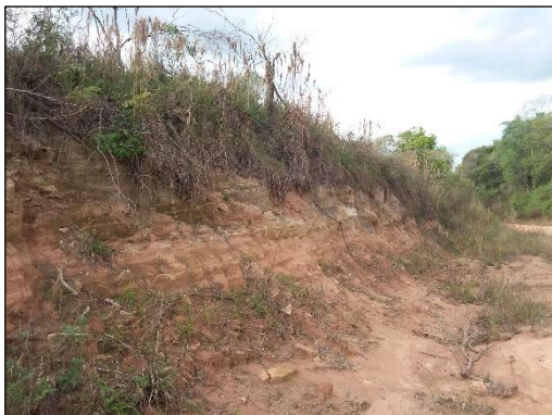
Foto 122. Rocha com intercalação de camadas de areia fina e argila. Grau R0. Coord.: -29,785397° e -53,888289°.
