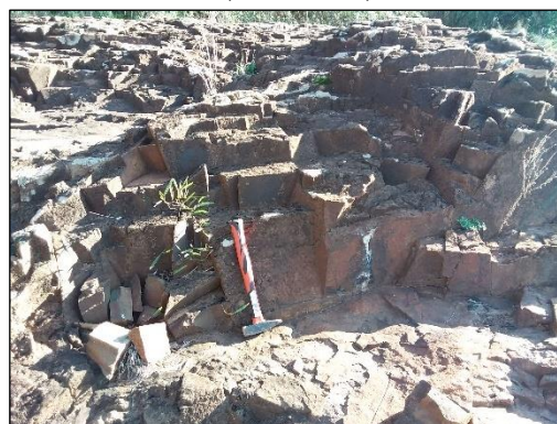
Foto 89. Alto índice de fraturamento da rocha. Coord.: -28,658417° e -54,463760°.
