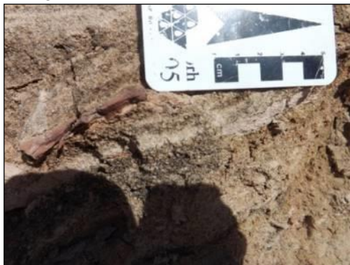
Foto 21. Camada de arenito e siltito em talude. Coord.: -29,596100° e -54,065700°.
