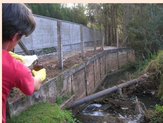
FIGURA 65 – TRANSBORDO DE AMOSTRA DE ÁGUA PARA FRASCOS COM REAGENTES PRESERVANTES NO PONTO OHL 05
