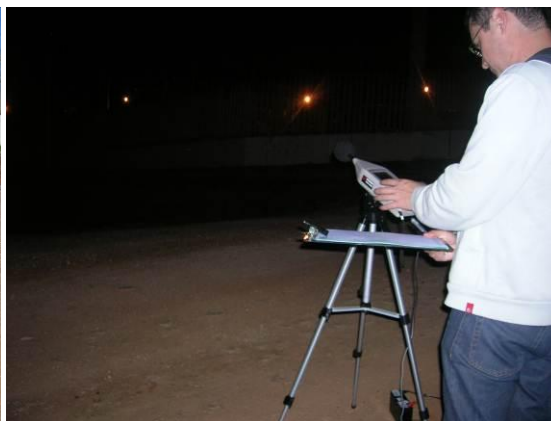
Monitoramento de Níveis de Pressão Sonora no ponto OHL 04R, próximo a uma Subestação da Copel.
