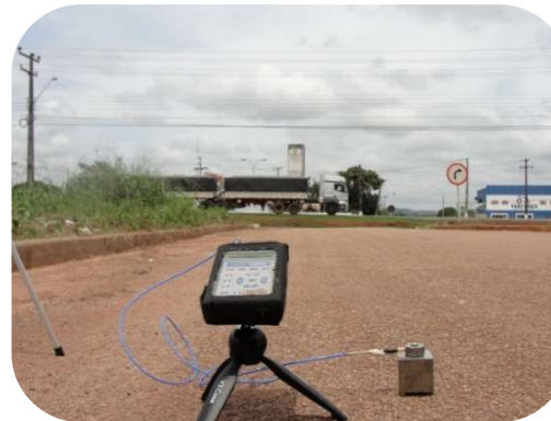
Medição de nível de vibração em área próxima a BR Pimenta Bueno/RO
