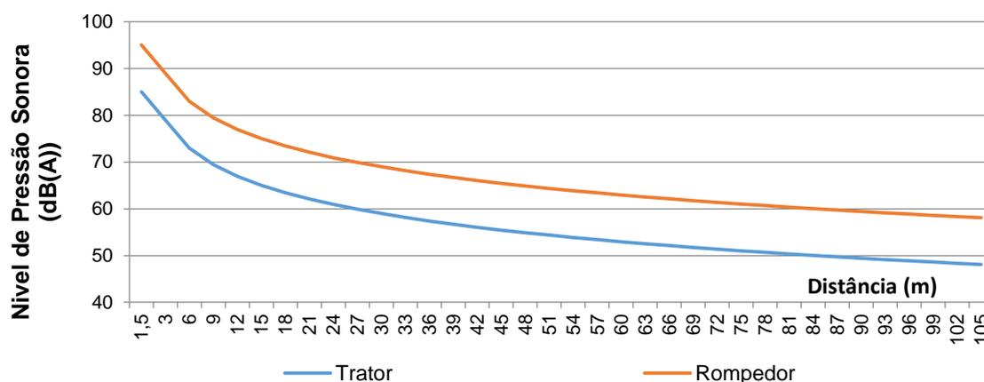
Figura 1: Curva do decaimento do ruído com o aumento da distância devido a operação de um trator e um rompedor de concreto calculado conforme Equação 1
