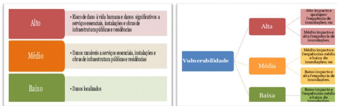
**Figura 5.77: Classes de grau dos impactos das inundações para um trecho de rio (esquerda) e Chave para determinação da vulnerabilidade a inundações em um trecho de rio (direita).**
