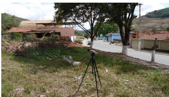
Figura 5.141 – Vista da comunidade avaliada, medidor de pressão sonora posicionado para a medição dos impactos sonoros sobre a comunidade.
