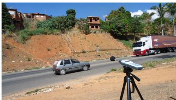
**Figura 5.130 – Vista da comunidade avaliada, medidor de pressão sonora posicionado para a medição dos impactos sonoros sobre a comunidade.**
