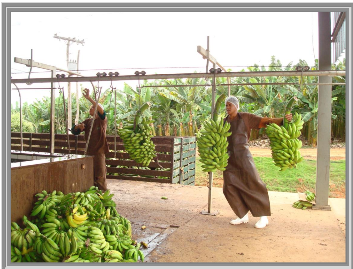
Itacarambi. Fazenda ICIL, galpão de beneficiamento, com linha de cabos de transporte de cachos entre área de coleta e galpão. Ao fundo, plantação de banana.
