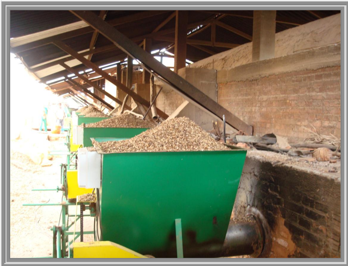
Itacarambi. Cerâmica, fornos queimam casca de mamona originada de indústria de processamento de oleaginosas (PETROVASF) da região.
