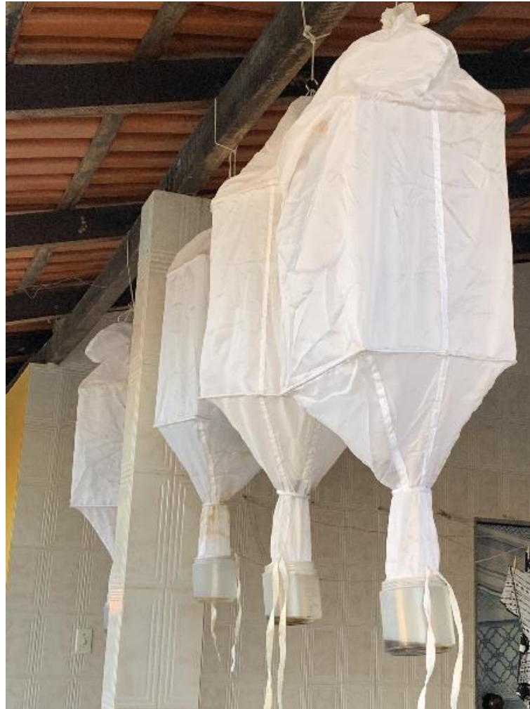
FIGURA 4.13 – EXTRATOR DE WINKLER MONTADO NO LABORATÓRIO DE ARACNOLOGIA DO MUSEU PARAENSE EMILIO GOELDI/PA
