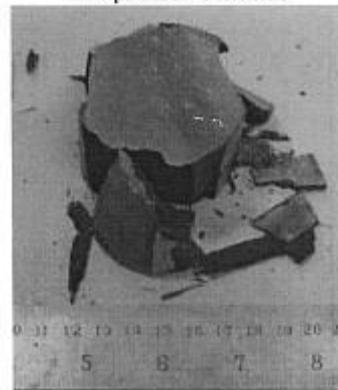
Foto 08 – Amostra 1.1010.14 após o ensaio de compressão uniaxial.
