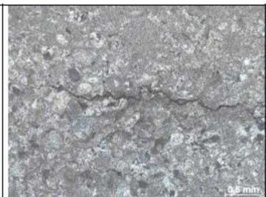
**B (aumento 50X/ luz polarizada)** – Detalhe dos cristais de carbonato nos níveis de granulação fina, exibindo contato irregular entre as faces. Presença de estilólitos.
