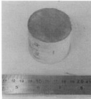
Foto 01 – Amostra 1.1007.14 antes do ensaio de compressão uniaxial.
