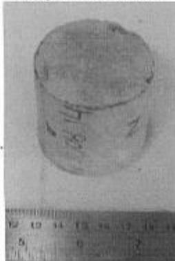
Foto 03 – Amostra 1.1008.14 antes do ensaio de compressão uniaxial.
