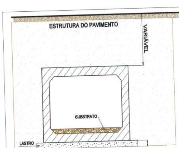
Figura 8.12 - Ilustração - Acompanhamento da execução do passa fauna terrestre
