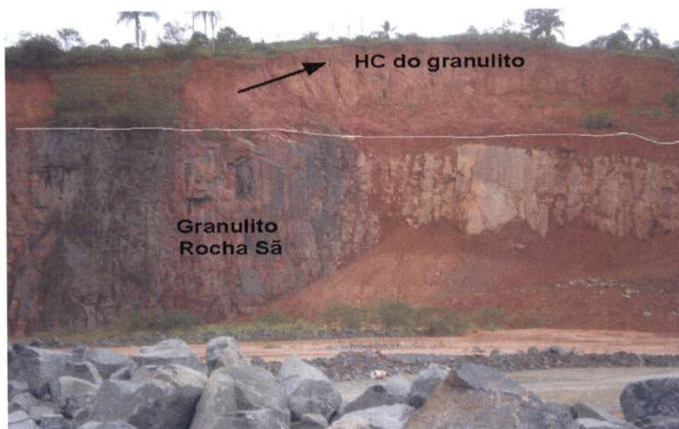
Figura 5.42 - Contato entre o HC do granulito e a rocha sã. Fonte: Autoria Prosul
