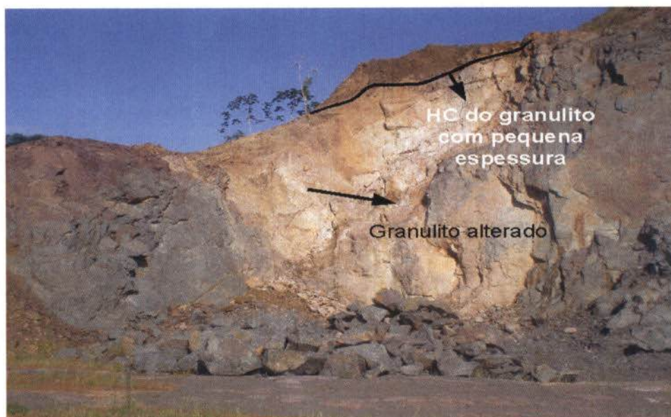
Figura 5.48 - Horizonte C do granulito que apresenta pequenas espessuras e granulito alterado. Fonte: Autoria Prosul
