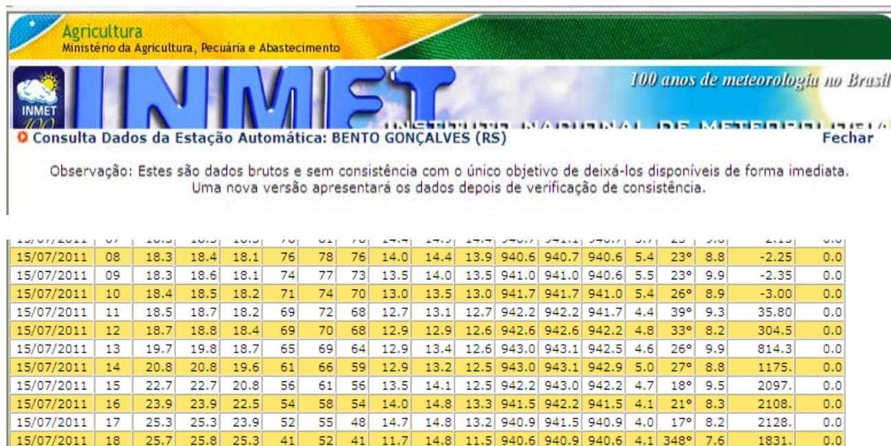
Esses dados complementam as avaliações de velocidade do vento obtidas in loco pelo equipamento anemômetro utilizado durante as medições de ruído a fim de identificar sua interferência durante a coleta. Os dados obtidos para a velocidade do vento através do INMET foram comparados segundo a Escala de Beaufort, a qual
