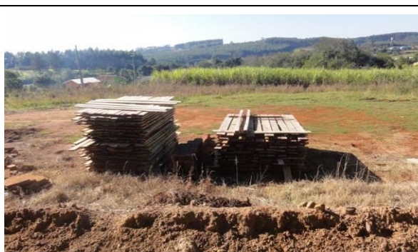
Tábuas resultantes do desdobramento das toras de pinus, empilhadas no pátio da Secretaria de Obras. 30/05/11.
