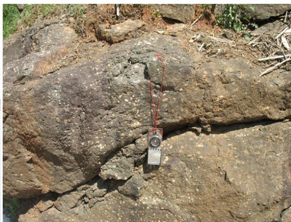
**Figura 36 – Detalhe do afloramento onde se observa a presença intensa de vesículas centimétricas preenchidas por zeólitas**
