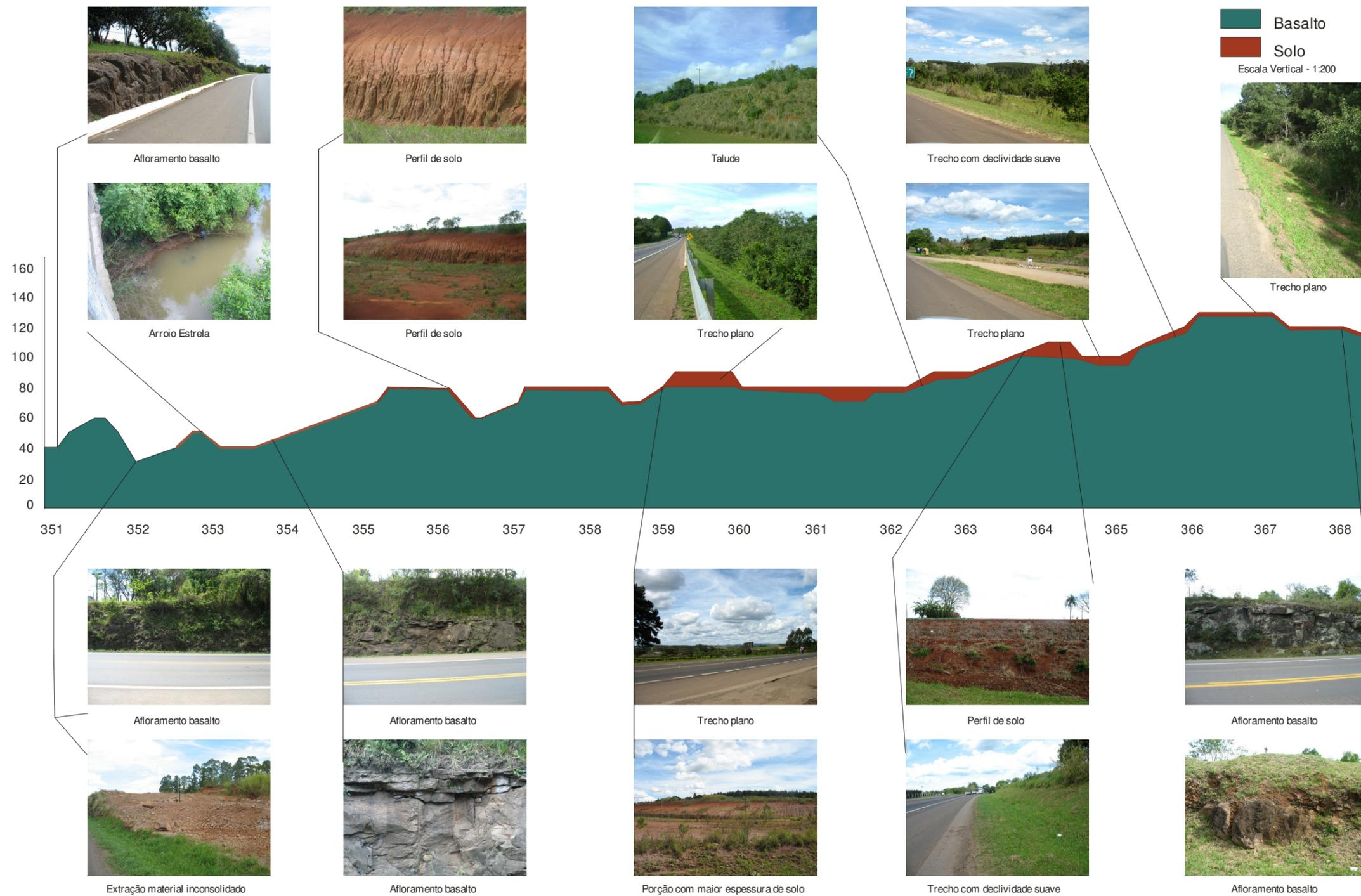
Figura 77 – Perfil topográfico, geológico e de solos do Trecho 1
