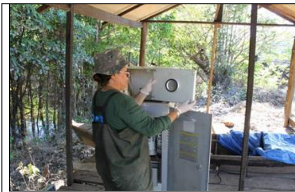
Figura 6.1.186 – Separação do adaptador para a instalação do Copo de Orifício usado na calibração do aparelho de monitoramento da Qualidade do Ar.
