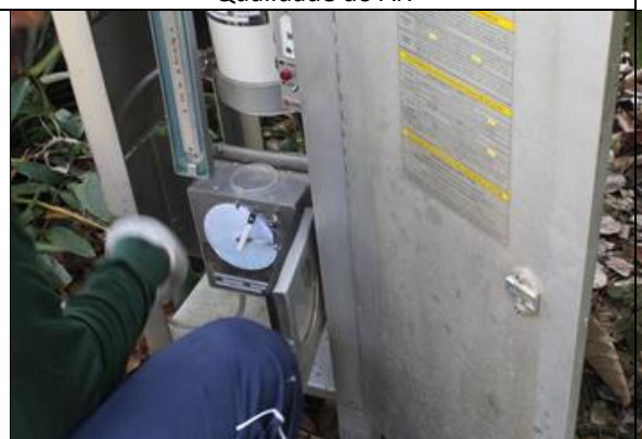
Figura 6.1.131 – Instalação do manômetro diferencial no equipamento de monitoramento da Qualidade do Ar.
