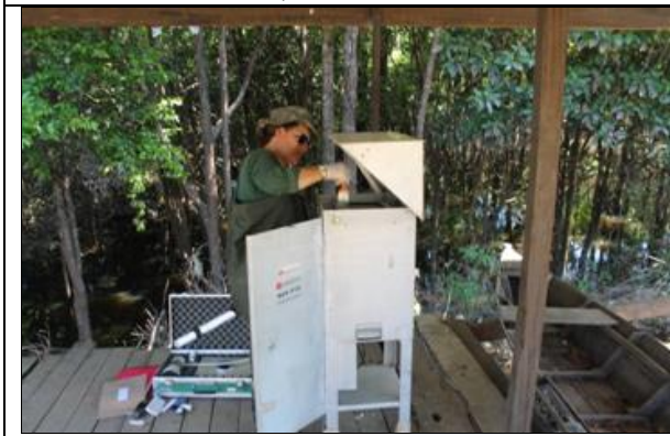
Figura 6.1.190 – Limpeza da poeira da porta filtro, oriunda do transporte do equipamento.
