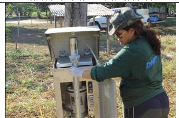
Figura 6.1.214 – Colocação do manômetro diferencial – preparação do equipamento de monitoramento da Qualidade do Ar.
