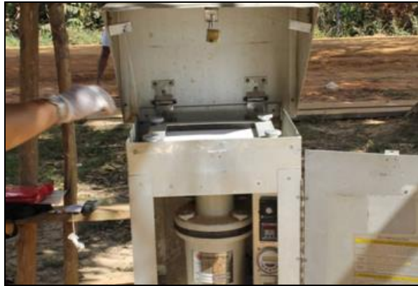
Figura 6.1.208 – Instalação do filtro de fibra de vidro utilizado no AGV para a retenção das Partículas Totais em Suspensão.
