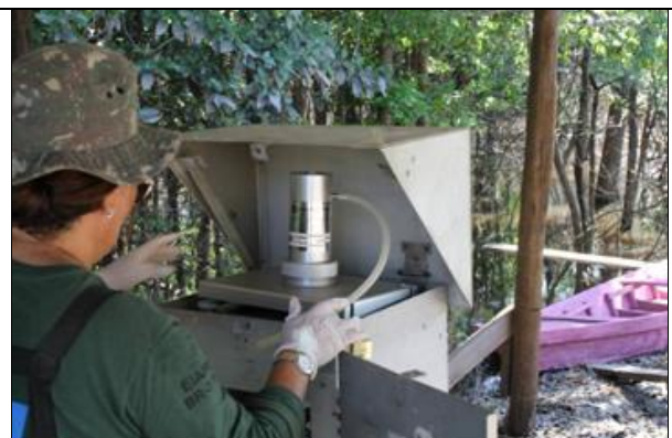
Figura 6.1.187 – Instalação do Copo de Orifício usado na calibração do aparelho de monitoramento da Qualidade do Ar.
