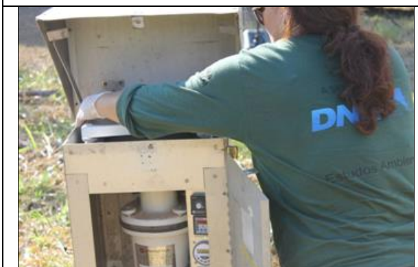
Figura 6.1.213 – Acoplagem da placa adaptadora para a instalação do copo de orifício.
