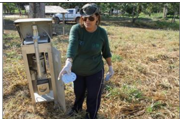
Figura 6.1.216 – Apresentação dos discos de 7 e 10 furos utilizados na calibração do aparelho de monitoramento.
