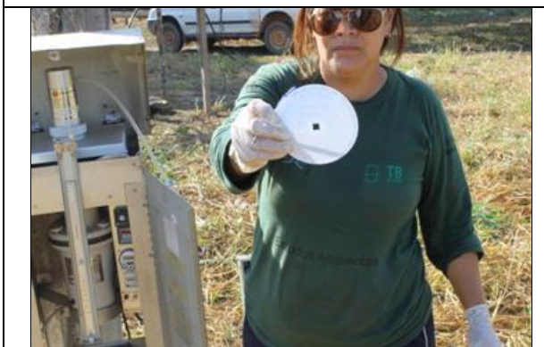
Figura 6.1.215 – Disco registrador antes da colocação no aparelho. Identificação do ponto de monitoramento e a data da realização das medições.
