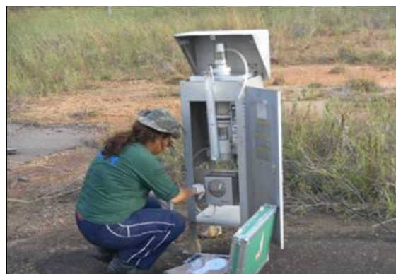
Figura 6.1.225 – Calibração do aparelho de Monitoramento da Qualidade do Ar.
