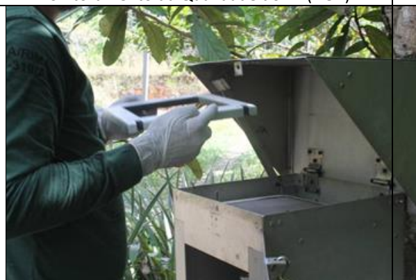
Figura 6.1.128 – Instalação do Aparelho de Monitoramento da Qualidade do Ar (AGV).
