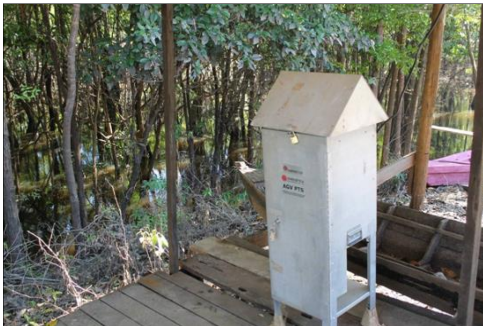
Figura 6.1.2 - Amostrador de Grande Volume para Partículas Totais em Suspensão AGV PTS utilizado nas atividades de campo da BR-319/AM. Coordenadas 20 M 621108 9417437. Fonte: Engespro. Data: 21/06/2014.
