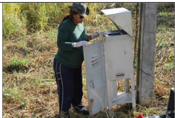
Figura 6.1.212 – Instalação do Aparelho de Monitoramento da Qualidade do Ar (AGV) sendo instalado no Ponto 14 – área residencial.
