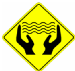
Figura 6.2.3.297 – Modelo da placa P8 “área de proteção de mananciais” associada aos corpos hídricos ao longo da rodovia. Fonte: DNIT, 2005.
