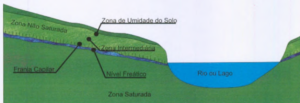
Figura 17 - Caracterização das zonas de um aquífero (modificado de ABAS, disponível na web).
