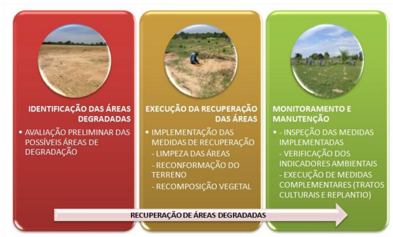
FIGURA 2.9.2 – ETAPAS DO PROCESSO DE RECUPERAÇÃO DE ÁREAS DEGRADADAS
