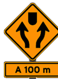
Sinal A.42.c – Início da Pista Dividida
