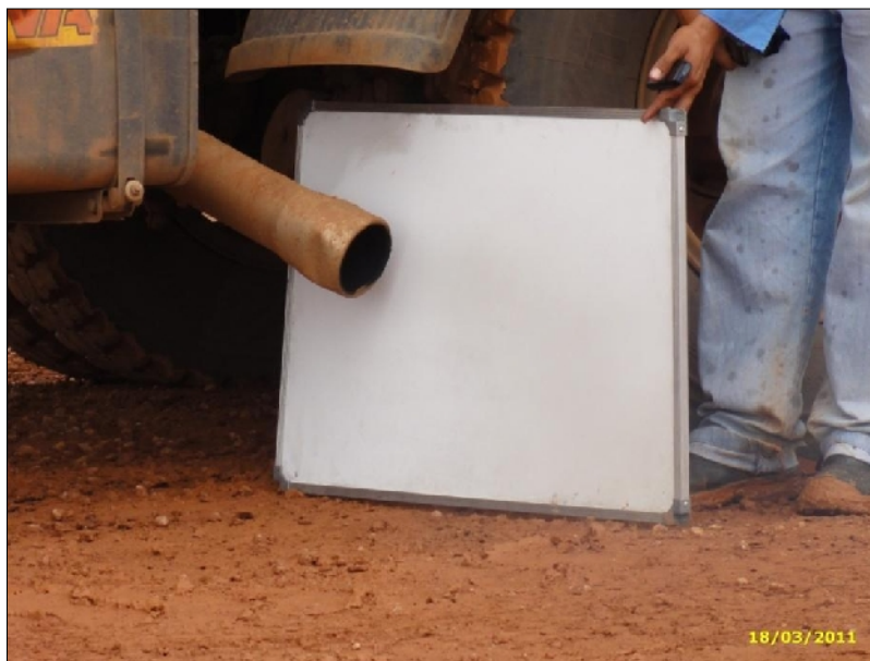
FIGURA 2.5.8 – MEDIÇÃO DA EMISSÃO DE FUMAÇA E FULIGEM DOS EQUIPAMENTOS PELO ÍNDICE DA ESCALA RILGELMANN (ITTI/UFPR, MAR 2011)
