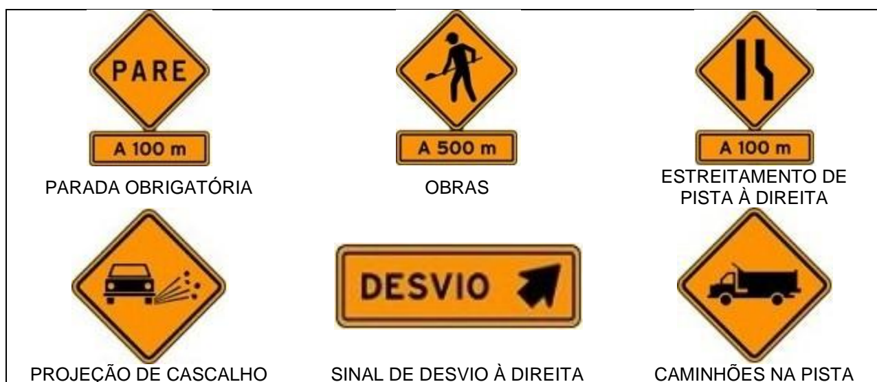
FIGURA 2.2.2– SINALIZAÇÃO ESPECÍFICA PARA OBRAS FONTE: IPR, 2005.
