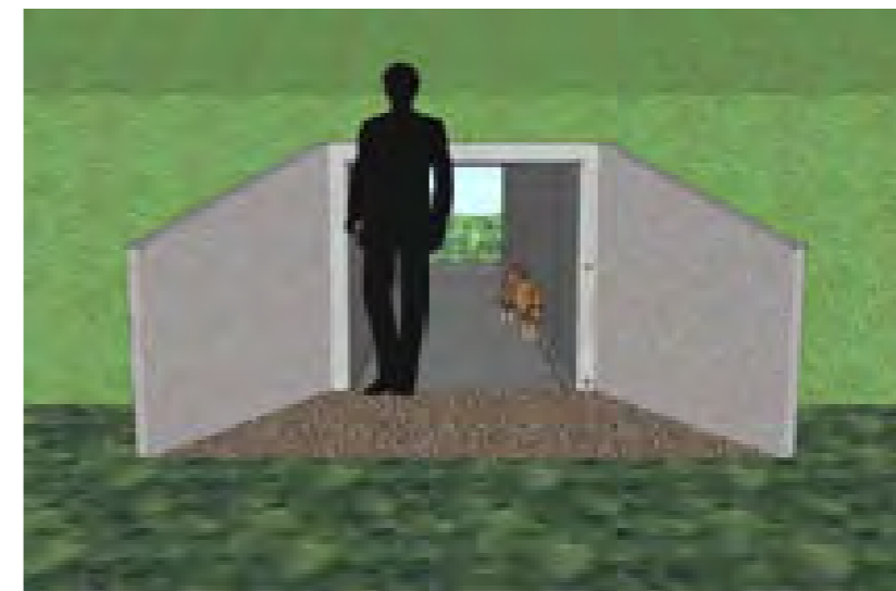
SEÇÃO TIPO DE PASSA-FAUNA (1,5 m x 1,5 m)
