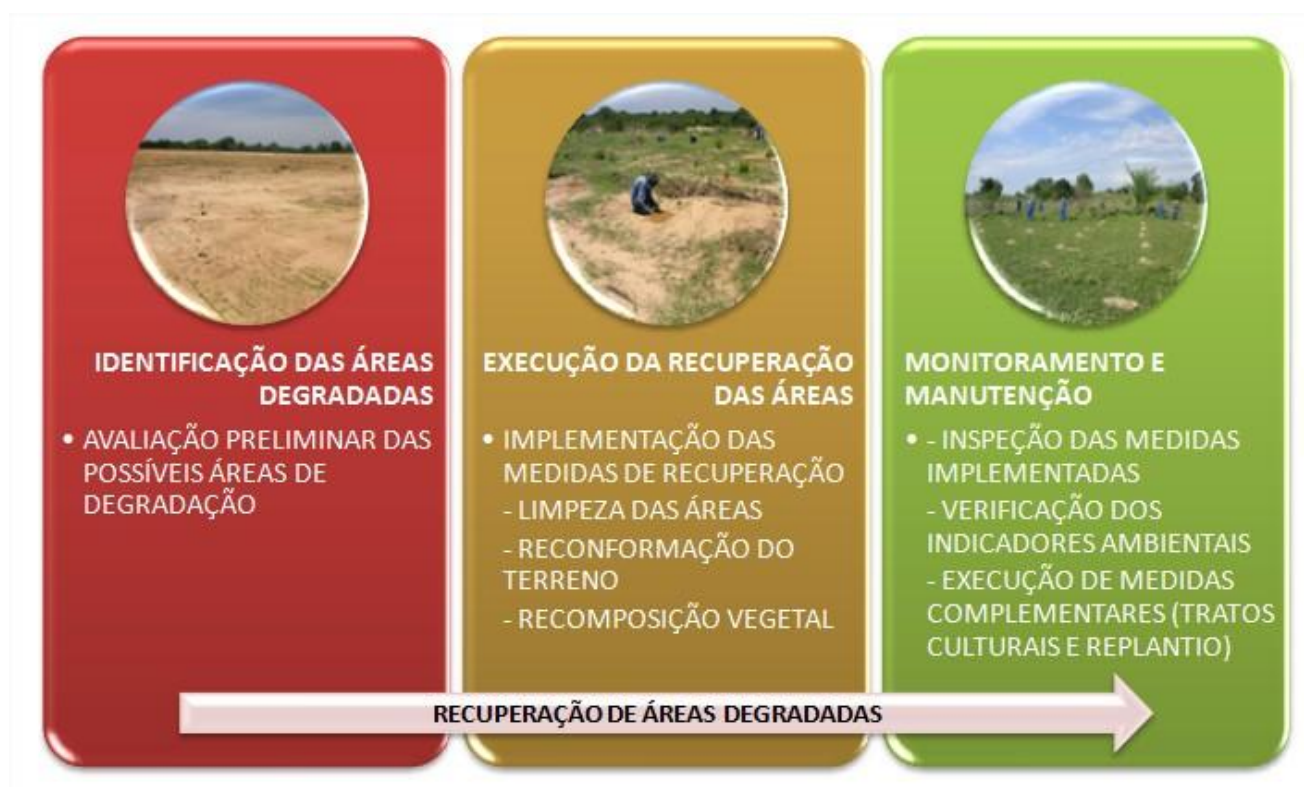
FIGURA 2.9.4 – ETAPAS DO PROCESSO DE RECUPERAÇÃO DE ÁREAS DEGRADADAS
