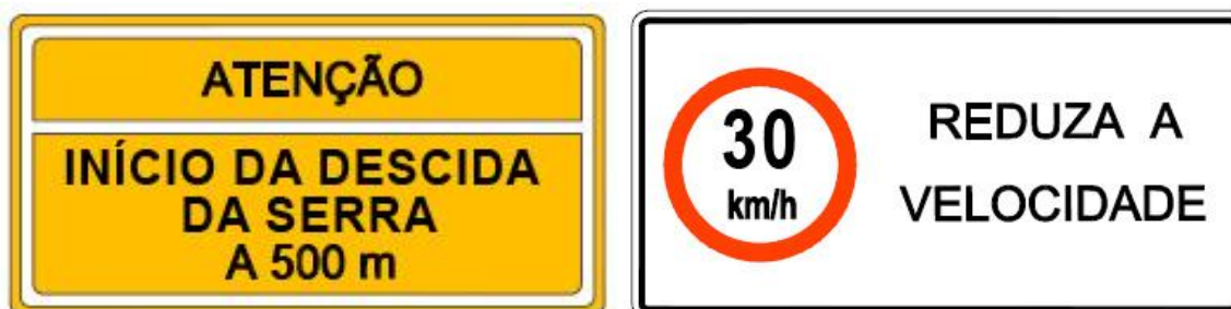
FIGURA 2.8.18 – PLACAS COMPOSTAS PARA AVISAR AO MOTORISTA SOBRE O INÍCIO DA DESCIDA DA SERRA
