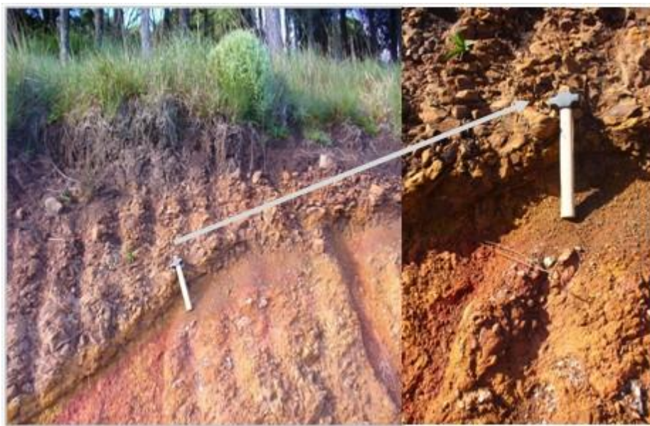
FIGURA 2.6.3 – INTEMPERISMO DIFERENCIAL EM BASALTO – ENTRE A SEDE DE SÃO JOSÉ DOS AUSENTES E KM 45+800 M FONTE: UFPR, 2011.
