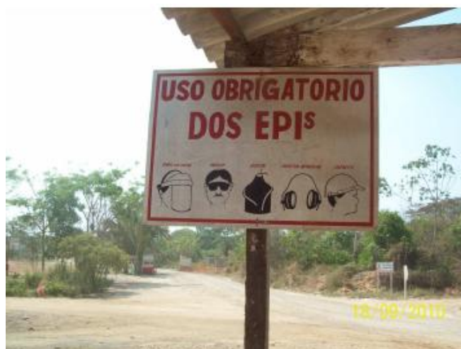
FIGURA 2.8.14 – PLACA DE ORIENTAÇÃO PARA USO DO EPI
