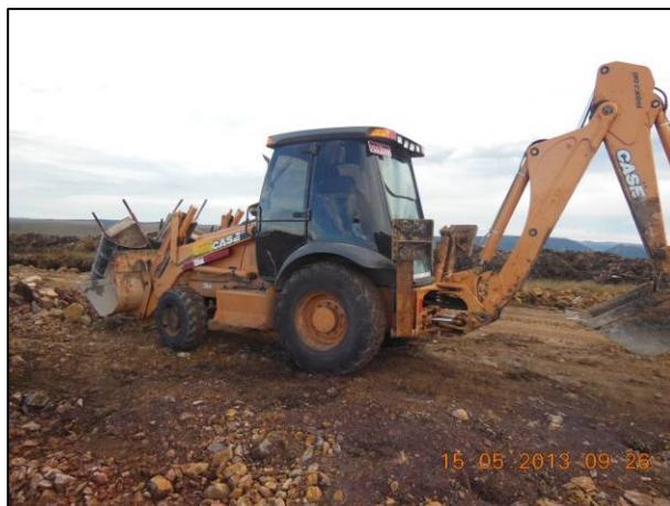
Retroscavadeira CASE 580M.
