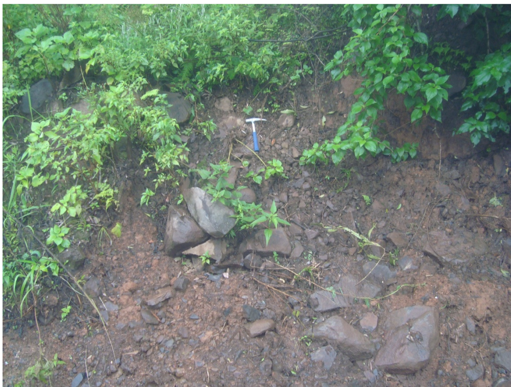
FIGURA 5.1.30 - FOTO: TALUS COM RISCO DE INSTABILIDADE COORDENADAS: LAT.: 6.812.528 N / LONG.:604.664 E / ALTITUDE: 682 M
