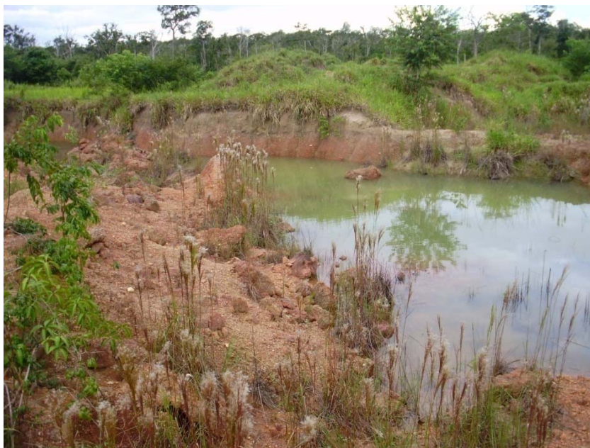
Figura 5-56: Cava aberta em ambiente úmido para exploração de cascalho laterítico.
