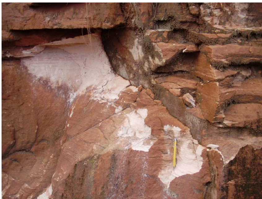
Figura 5-06: Afloramento de arenito da Formação Utiariti exposto no vale do rio Ronuro ao longo do traçado estudado como “Alternativa C” para a BR-242
