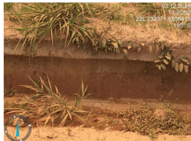
Figura 46: Solo exposto. Latossolo Vermelho-Amarelo com textura média argilosa. Solos profundos com baixa plasticidade e baixa retenção de água.
