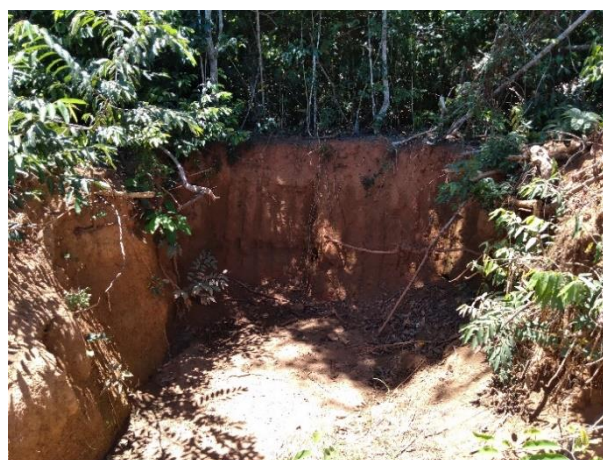
Figura 44: Latossolo em corte de estrada, com pequenas lentes lateríticas. Textura barro argilosa, horizontes A, B e C, profundidade de 1,80 m, característica plástica.
