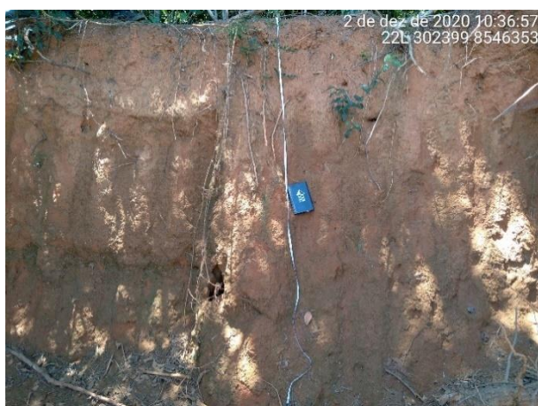
Figura 49: Ocorrência de Plintossolo com pequenas lentes de plintita. Horizontes A / B, pouca presença de argila, solo friável, profundidade de 2,30 m, com estrutura granular simples.
