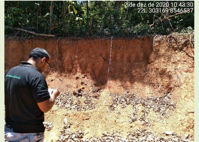
Figura 40: Perfil de latossolo vermelho, com concreções e demais materiais, que podem ser utilizados na implantação do empreendimento.
