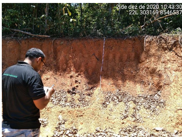
Figura 43: Perfil 2,5 m de exposição – Latossolo Vermelho Distrófico. Textura barro argilosa, horizontes A, B e C, profundidade de 1,80 m, característica plástica.
