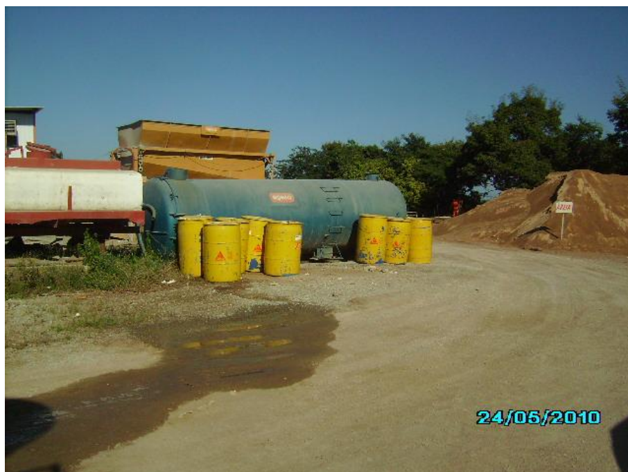
FIGURA 7 – DEPÓSITO DE ADITIVOS ESTOCADOS AO TEMPO
