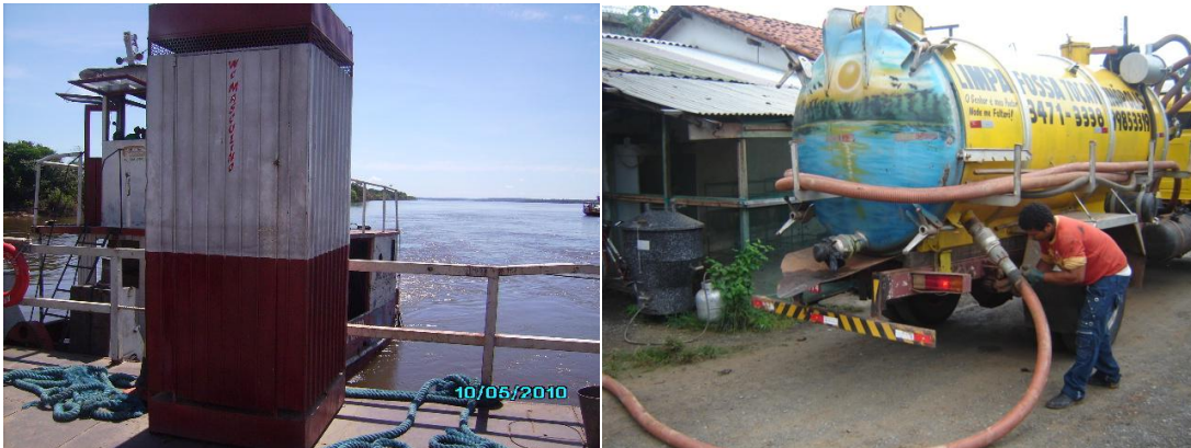
FIGURA 12 – BANHEIRO MÓVEL SOBRE A BALSA E CAMINHÃO DE LIMPEZA DA FOSSA
