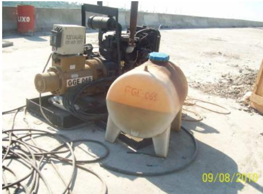
FIGURA 6 - RECIPIENTE DE COMBUSTÍVEL COM BANDEJA DE CONTENÇÃO
