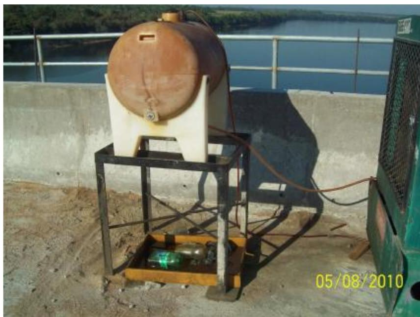
FIGURA 7 – MÁQUINA COM BANDEJA DE CONTENÇÃO
