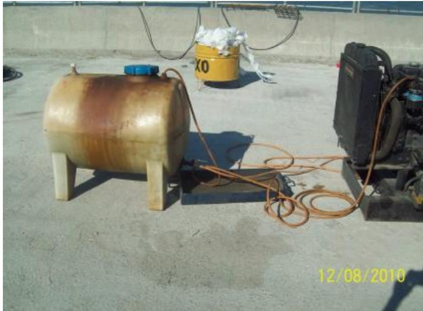
FIGURA 8 - RECIPIENTE DE COMBUSTÍVEL COM BANDEJA DE CONTENÇÃO
